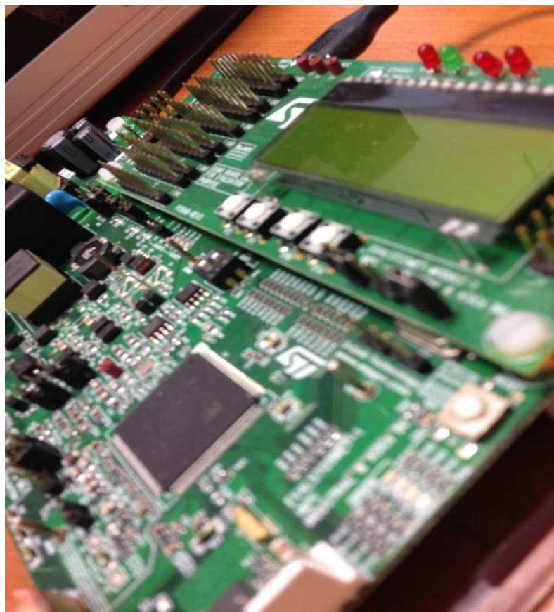
Fig. 5.2. - Platforma de evaluare pentru contorizare inteligentă PLC STMicroelectronics (ST)
