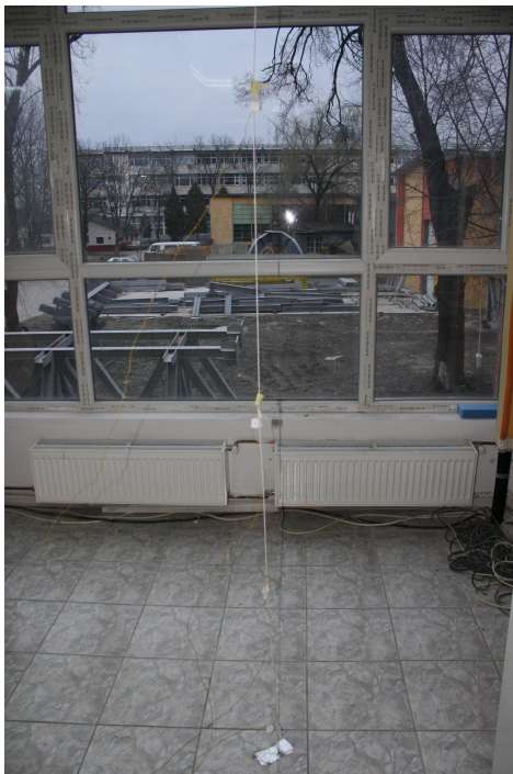
Poză B6 – Poziționarea termocuplelor și loggerelor pe verticală
