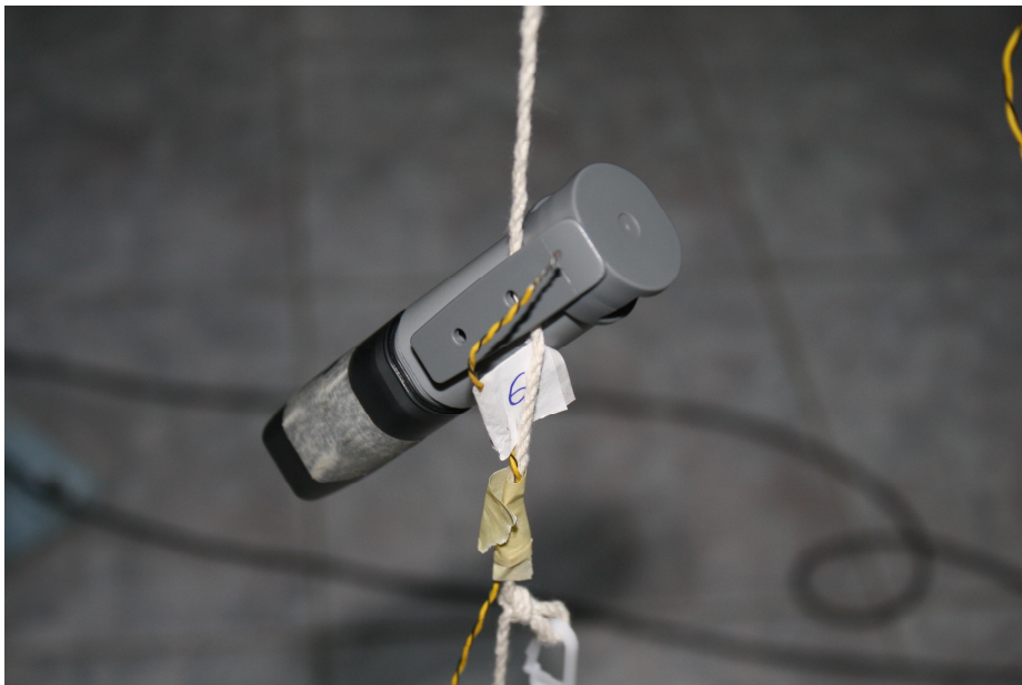
Poză B8 – Logger pentru măsurare temperatură și umiditate relativă
