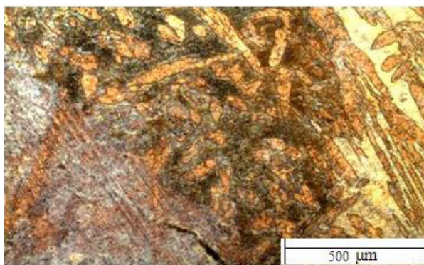
Figura 3.34. Zona cu defect de tipul fisurii - CuZnAl
