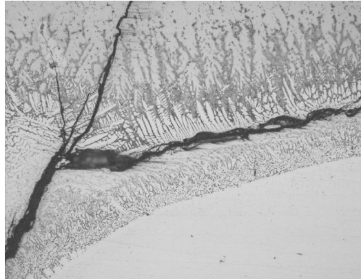
Figura 1.24 Fisuri apărute la sudarea NiTi cu un oțel inoxidabil [62]
