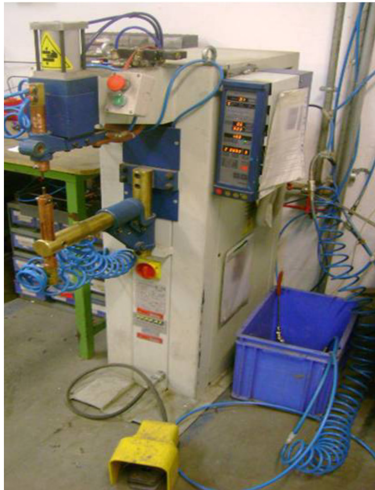
Figura 2.5 Vederea de ansamblu a instalației de sudare electrică prin presiune în puncte PPN28.
