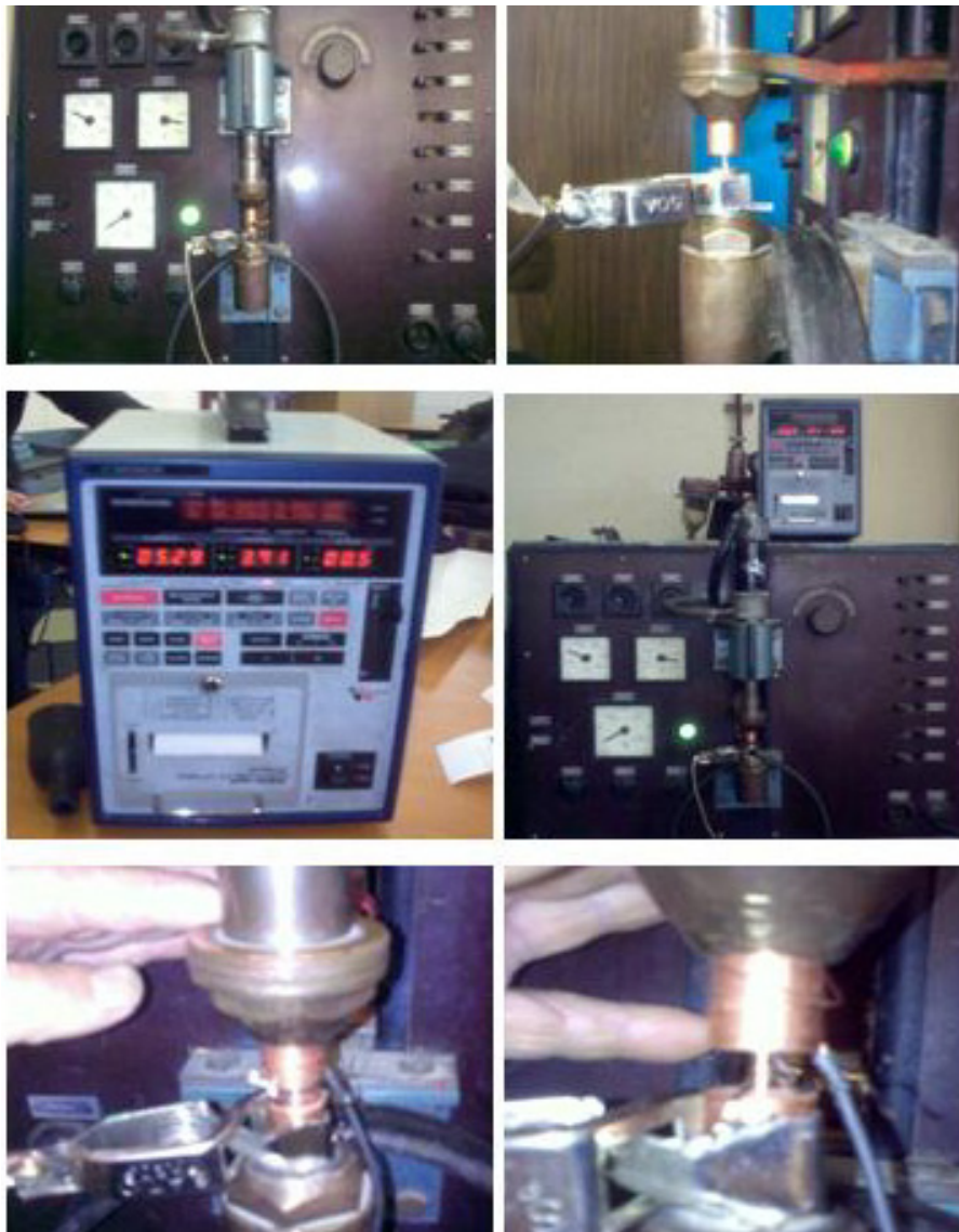
Figura 3.5 Instalația experimentală de sudare cu energie înmagazinată
