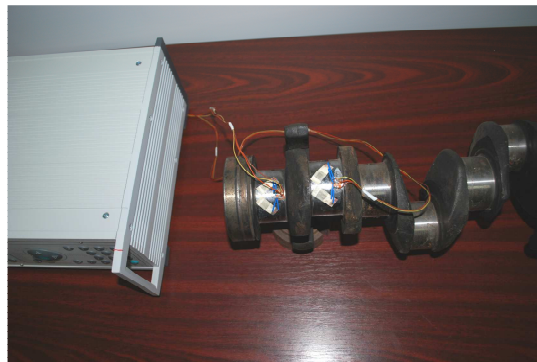
Fig. 6.1. Poziția fixării timbrilor tensometrice pe manivela arborelui.
