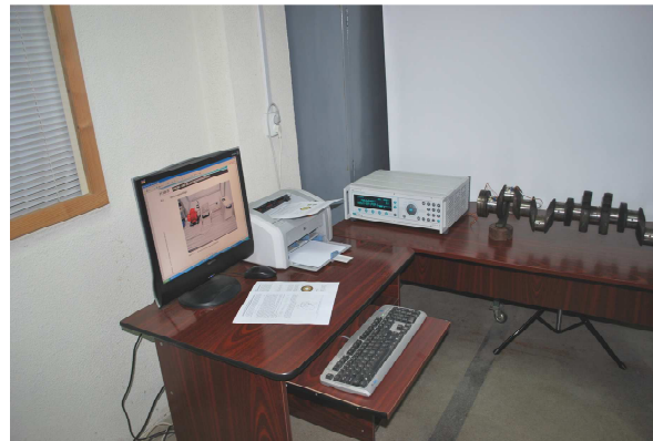
Fig. 6.2. Stand pentru încercări experimentale prin metode tensometrice.
