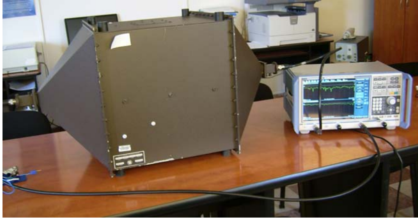
Fig. 4.23 Celula TEM IFI CC-104SEX, văzută din spate, și analizorul vectorial de rețea R&S ZNB utilizat la dozimetria experimentală
