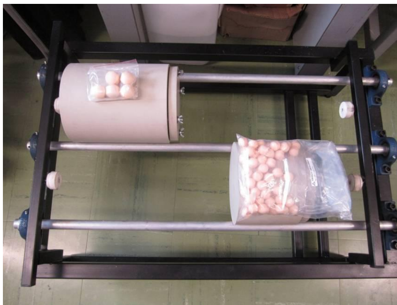
Figura 3.7 Instalația utilizată pentru mărunțirea pudrei obținute după calcinare, și pentru realizarea amestecului de barbotină Pompa de vacuum (VWR vacuum gas pump, USA)
