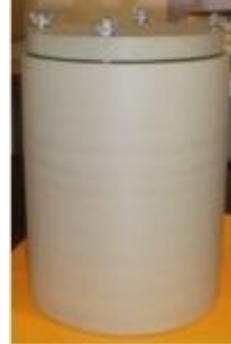
Figura 4.4 Bilele de aluminiă utilizate pentru măcinare și barbotina b) Containerul din polipropilenă în care este introdusă pudra și bilele de aluminiă
