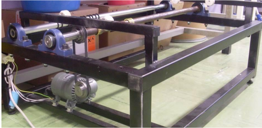
Figura 4.3 Instalația de măcinare a pudrei obținute și de realizare a barbotinei
