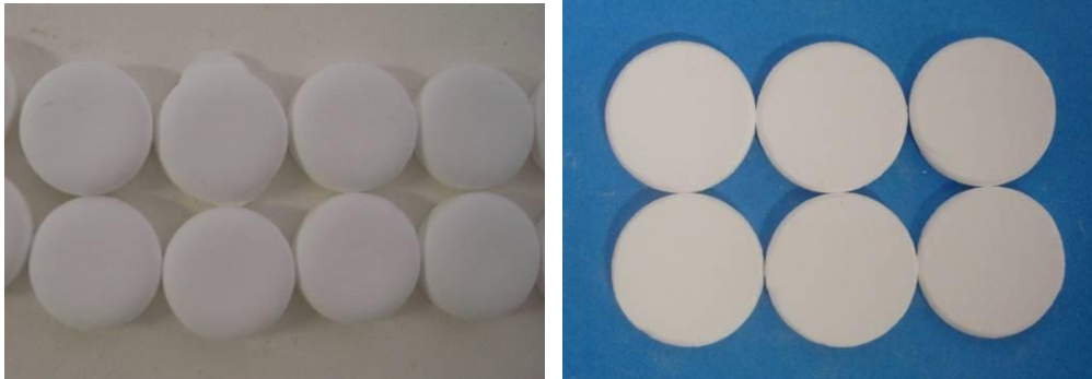
Figura 4.10 Pastile demulate; a. neșlefuite ; b. uscate și șlefuite
