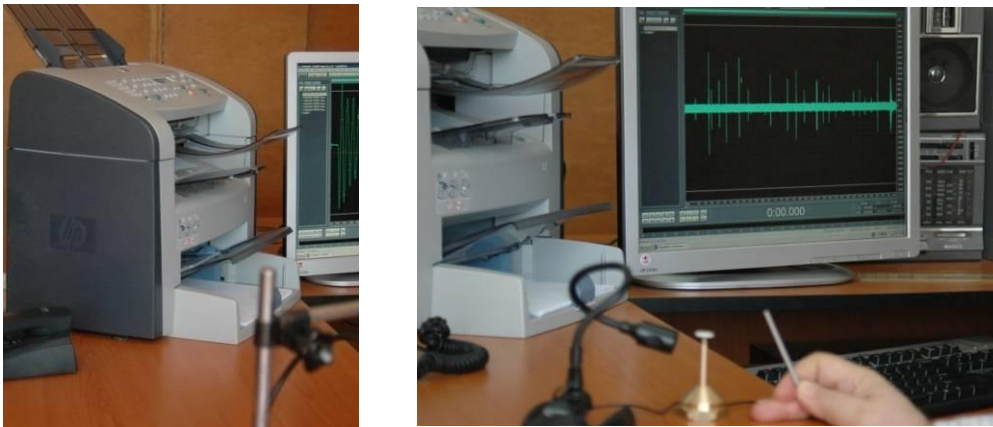
Figura 3.34 Standul experimental pentru înregistrarea răspunsului sonor: a. placă liberă; b. placă rezemată în centru
