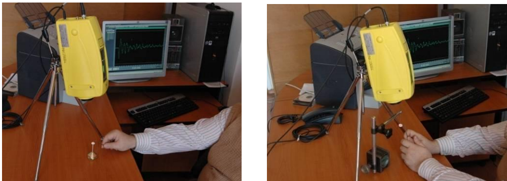
Figura 3.35 Standul experimental pentru înregistrarea semnalului prin fascicul laser: a. placă liberă; b. placă rezemată în centru
