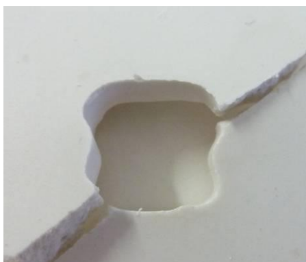
Figura 4.34 Mulaj de gips pentru turnarea implanturilor osoase
