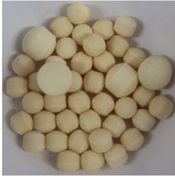
Figura 4.4 Bilele de aluminiă utilizate pentru măcinare și barbotina b) Containerul din polipropilenă în care este introdusă pudra și bilele de aluminiă
