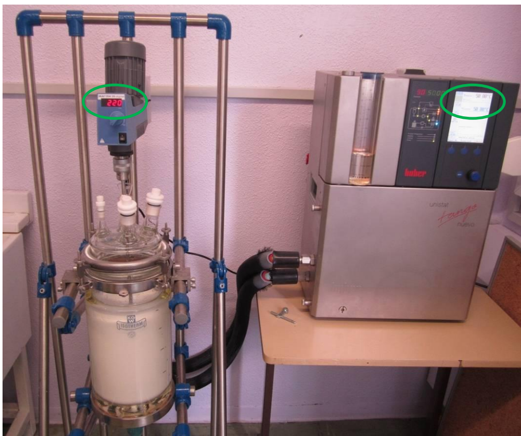
Figura 4.2 Instalația de sinteză a hidroxiapatitei compusă din bioreactor și termostat
