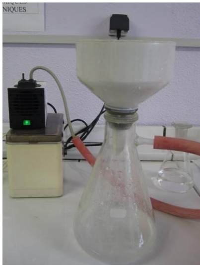
Figura 3.4 Instalația de filtrare alcătuită din pompa de vacuum și suportul ceramic de filtrare
