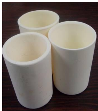
Figura 3.6 Vase realizate din alumina pentru calcinarea pudrelor de
