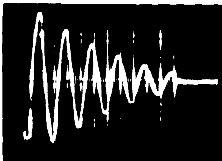
Fig.4.15. Fotograma tensiunii măsurată la începutul fazei pentru motorul de 1,5 KW.
