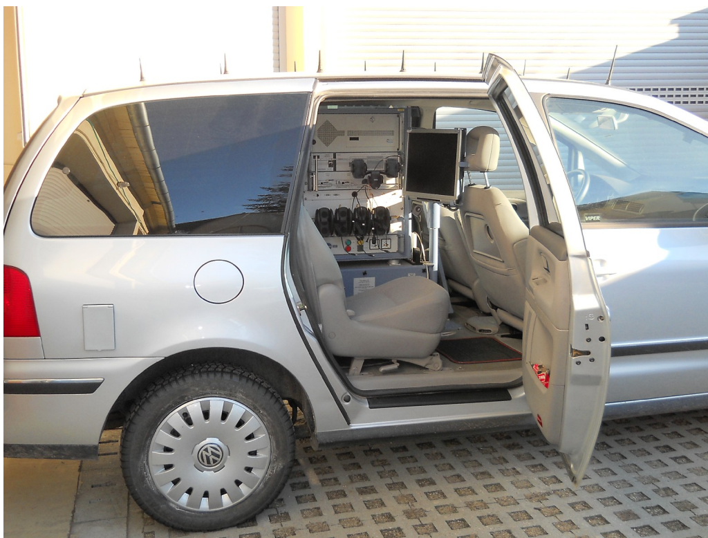
Fig. 4.4: Autospecială Rohde&Schwarz RADIS din dotarea ANCOM pentru măsurarea acoperirii rețelelor mobile: se observă rack-ul de aparatură și multitudinea de antene de pe capotă. Din arhiva autorului.
