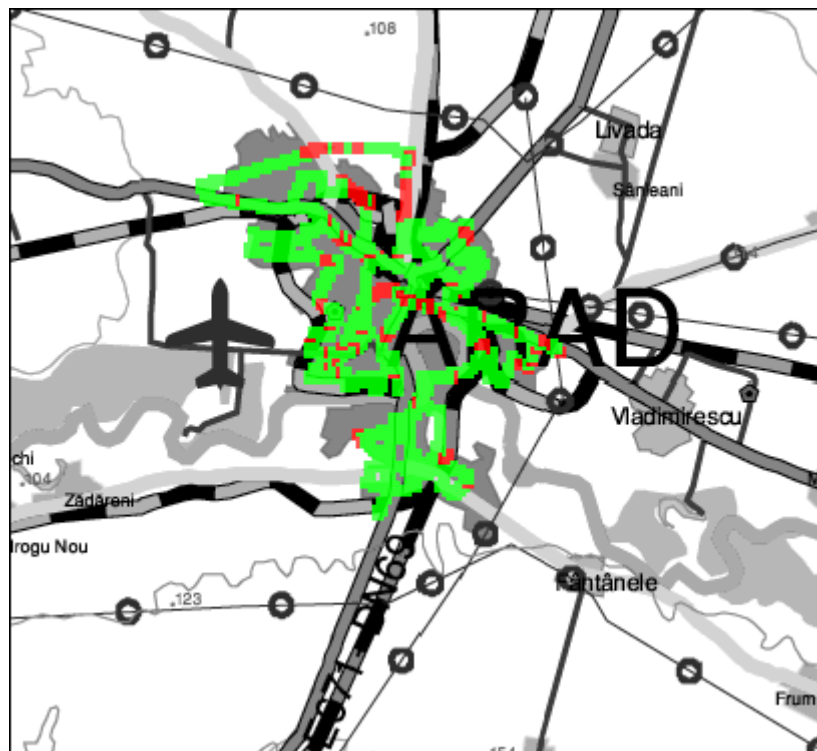
Fig. 4.5: Exemplu de traseu de măsurare acoperire pentru municipiul Arad, campanie de măsurări 2011. [R3G2].
