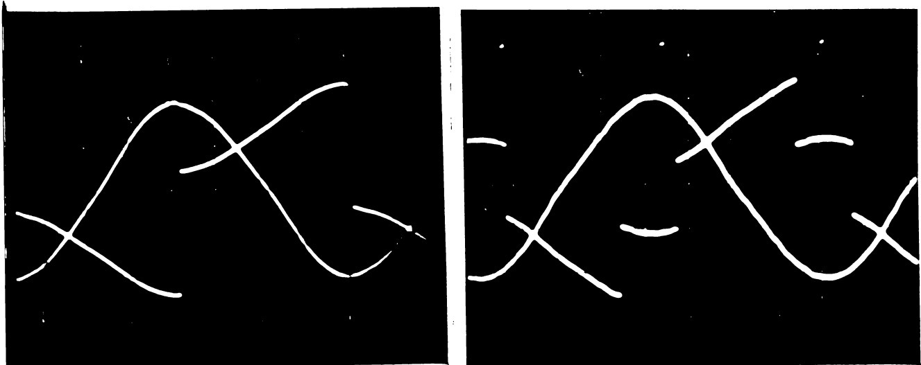
Fig. 5.6. Tensiunea pe faza S față de tensiunea sinusoidală de pe faza R la unghi de conducție de 180^\circ el. și 120^\circ el. Tensiunea în unități relative : 0,5 u.r./div. 50 Hz.
