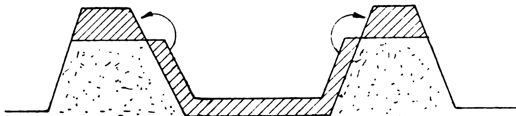
Fig. 3.10 Secțiune rambleu realizată prin tehnologie îmbunătățită.
