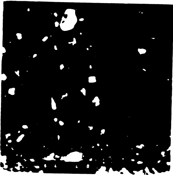
Fig.111. Distribuția punctiformă de pigment 12 într-o glazură microcristalină (55 x).
