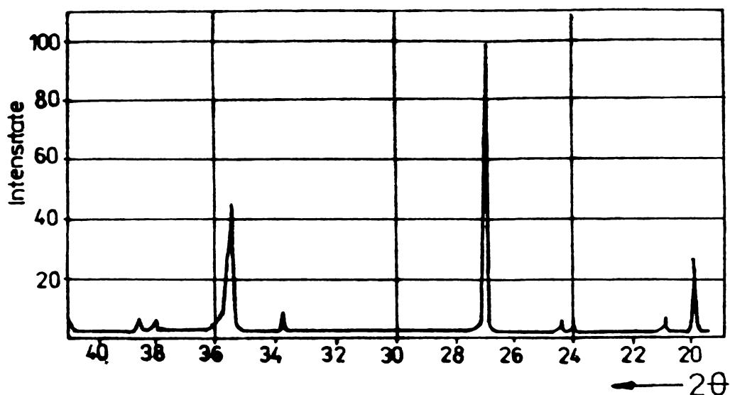
Fig.67. Spectrul de difracție al razelor X pentru compoziția 5 (pigment galben)
