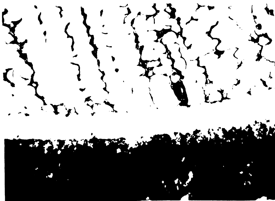
Fig.11.6. Microstructura depunerii de stelit 6 pe oțel cu 0,25 % C. Structura de supraîncălzire. (Atac: Murakami x 500)
