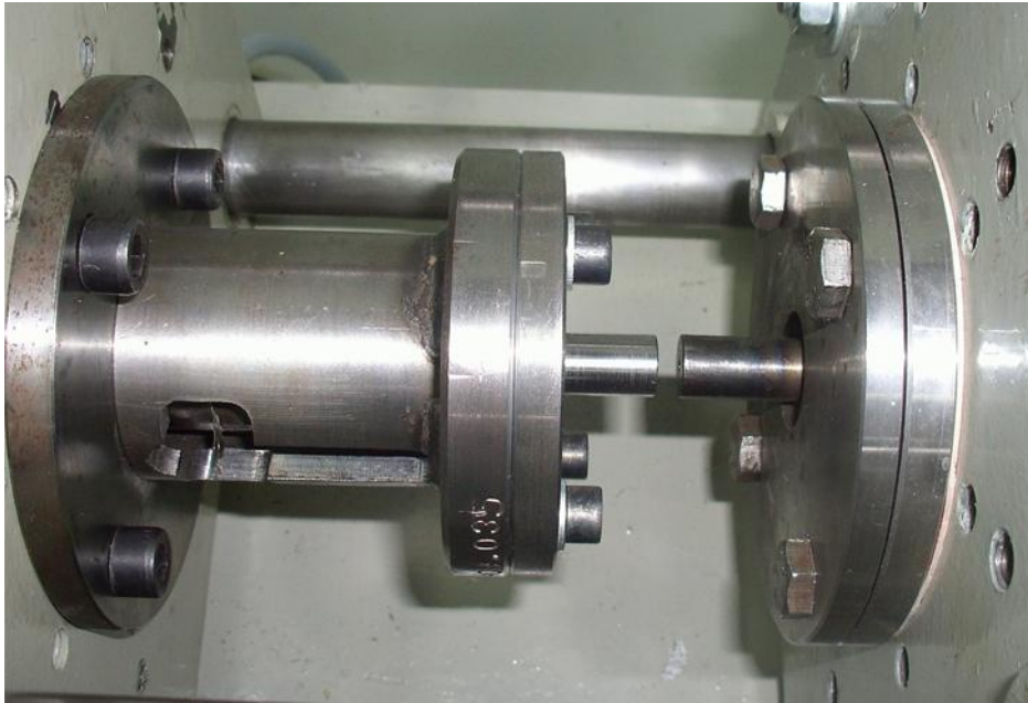
Fig.5.7. Matriță pentru microinjectare activată ultrasonic
