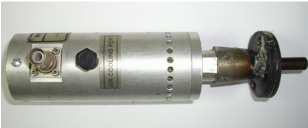
Fig.3.3. Transductor piezoceramic cu sistem de răcire integrat
