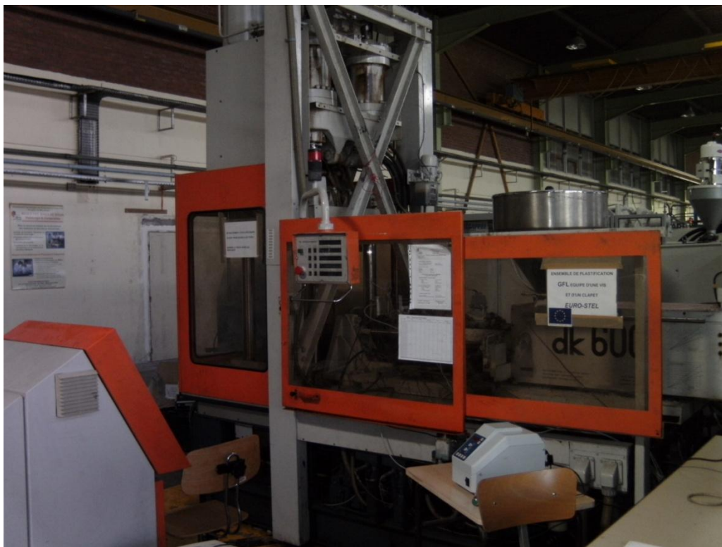
Fig. 4.1. Mașină de injectat DK Codim 200-600 Verticale
