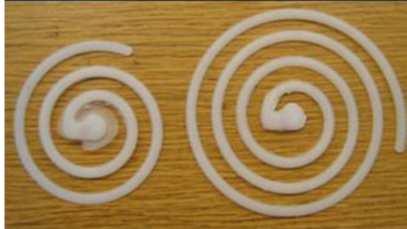
Fig.2.15 – Spirale Griffith corespunzătoare injectării cu sau fără ultrasunete [www.ultramelt.ro]
