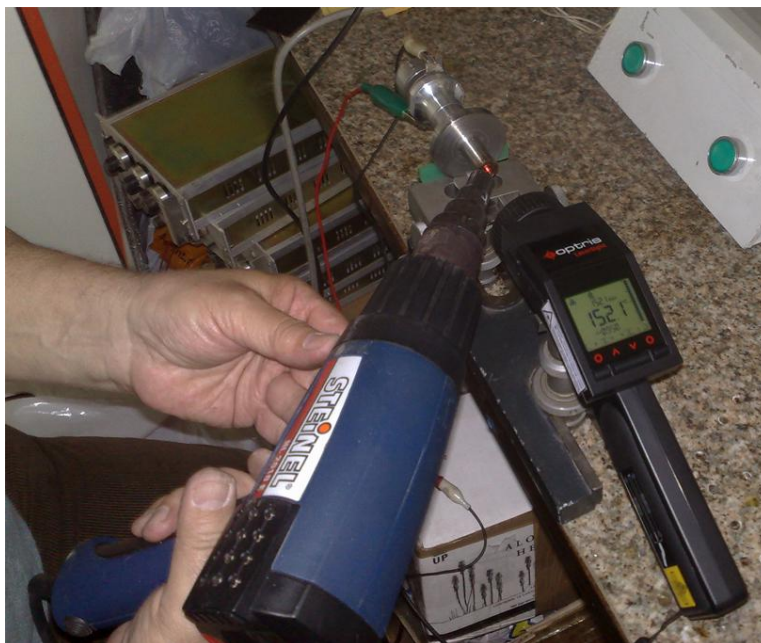
Fig. 4.10. Determinarea frecvenței de rezonanță la diferite temperaturi
