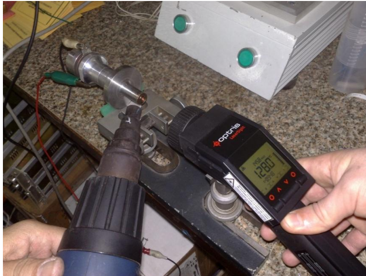
Fig. 3.30. Montaj experimental pentru studiul efectului termic al activării ultrasonice
