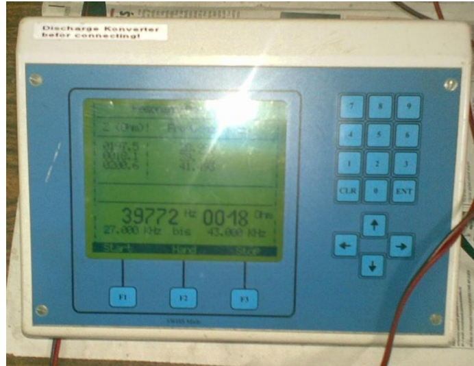
Fig. 3.28. Determinarea frecvenței de rezonanță și a impedanței acustice a convertorului ultrasonic
