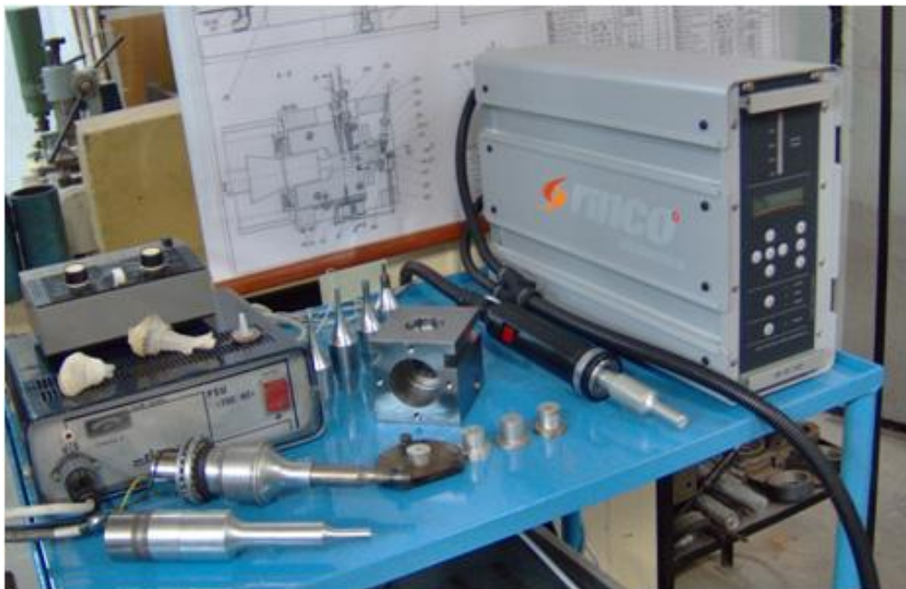
Fig.2.13. Echipamentul ultrasonic-generatoare și convertoare (transductor+concentrator) [construcție UPT]
