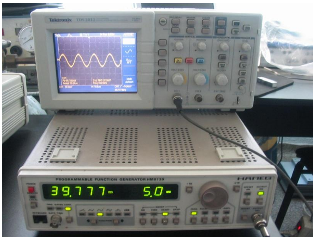
Fig.3.5. Stand experimental de măsurare a frecvenței de rezonanță compus dintr-un generator de semnal HAMEG și un osciloscop Tektronix
