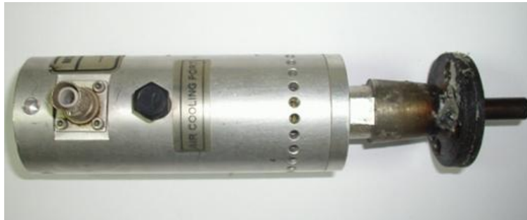
Fig. 4.12. Transductor piezoelectric cu sistem de răcire integrat și concentrator
