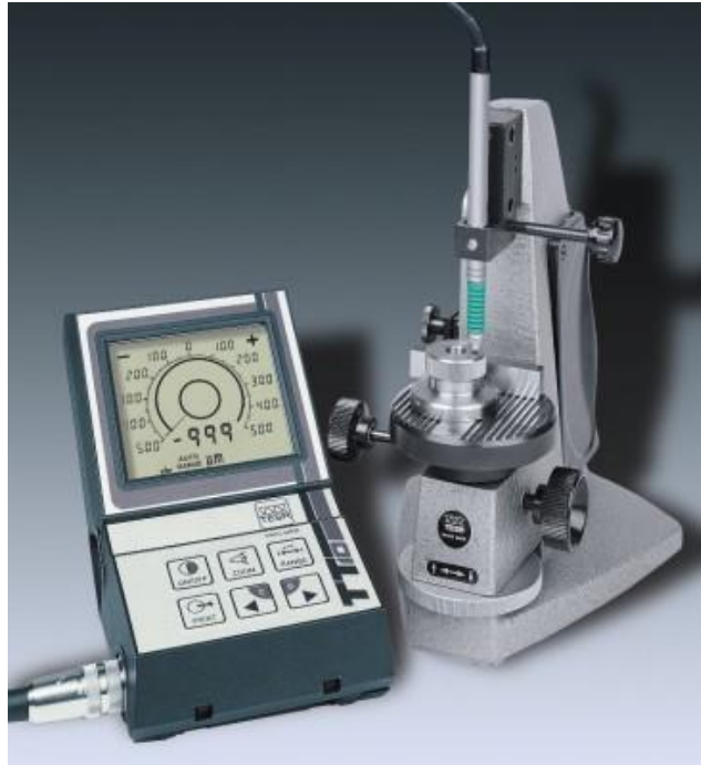
Fig.3.6. Echipament de determinare a amplitudinii de oscilație a undelor mecanice Tesatronic TT10
