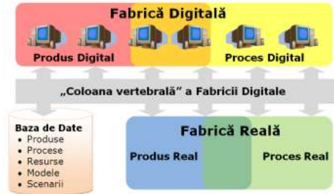
Fig. 2.5 „Coloana vertebrală” a fabricii deschise, după (Kuehn, 2007)
