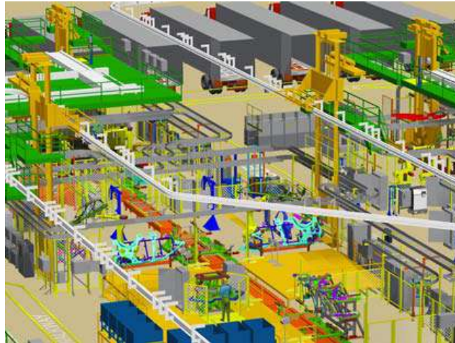
Fig. 2.14 Construcția liniilor de producție folosind obiecte predefinite de vizualizare 3D (Siemens, 2010)
