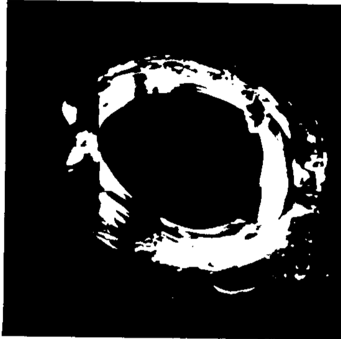
Foto 7. ALEZAJ STRĂPUNS ÎN OTEL ALIAT 18.8 CM; s = 0,75 mm; W_z = 5 kJ; \tau = 6 \cdot 10^{-6} s; 9 impulsuri; F = 50 mm; alezaj conic, teșit la intrare; fara fisuri radiale în zona intrării; D_2 = 0,230 mm, d = 0,075 mm.
