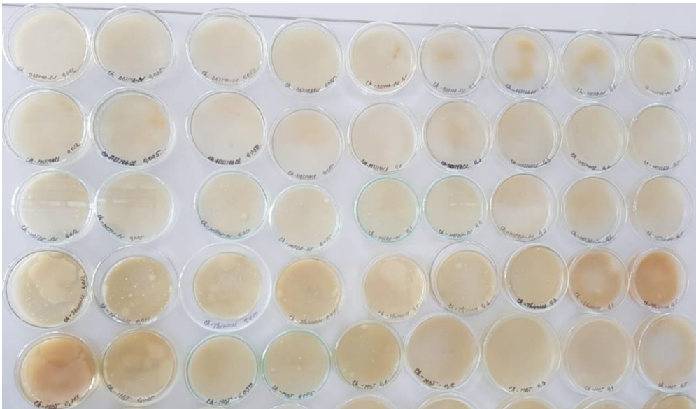
Figura 3.16. Materiale obținute prin funcționalizarea CH, testate în plăci Petri cu inocul heterotrof și incubate
