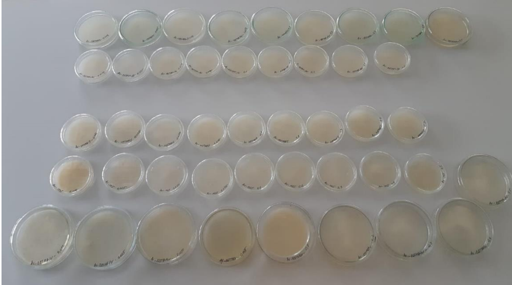
Figura 3.15. Materiale obținute prin funcționalizarea CE, testate în plăci Petri cu inocul heterotrof și incubate
