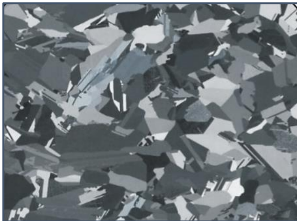
Fig. 1.2. Cristalite în structura unui solid policristalin.
