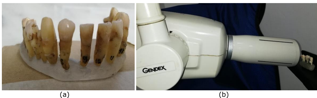
Figura 3.1. (a) Dinți pregătiți pentru investigații cu raze X; (b) dinți poziționați în unitatea de raze X Gendex Oralix (Danaher Corporation, Washington DC, SUA), pregătiți pentru expunere.
