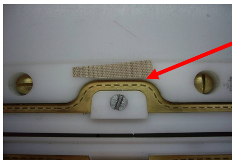
Fig.159. Zona din matrița de sudare cu spațiu între electrod și gidaj
