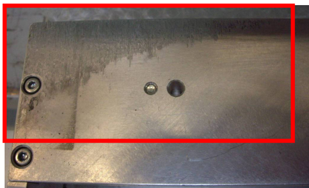
Fig.160. Reprezentarea matriței de sudare supusă la presarea neuniformă Evitarea acestor defecte, destul de dese, se face prin repararea matriței de sudare și poziționarea a 4 blocuri din plastic în interiorul mesei mașinii, de aceeași
