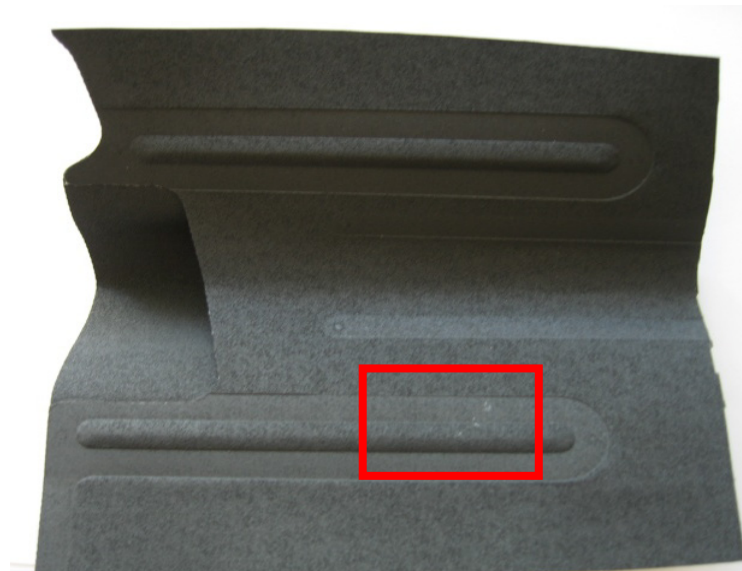
Fig.157. Reprezentarea defectului impurități în îmbinarea sudată
