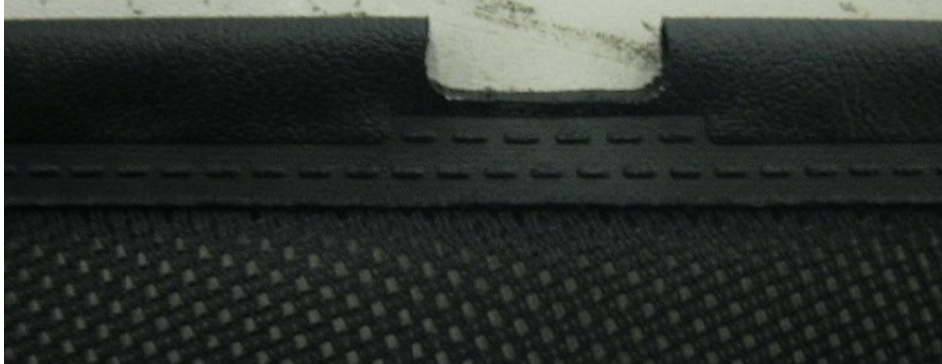
Fig. 135. Reprezentarea defectului suprapunerea materialului PVC
