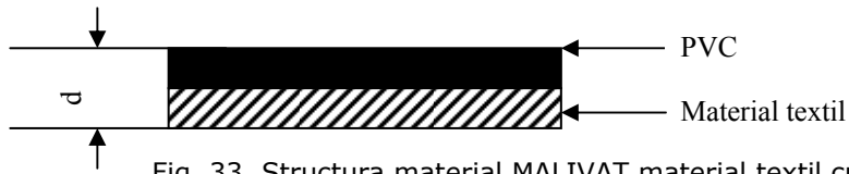
Fig. 33. Structura material MALIVAT material textil cu PVC
