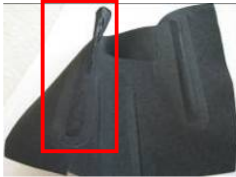
Fig.154. Defectul-Lipsa inserției metalice pentru rigiditate
