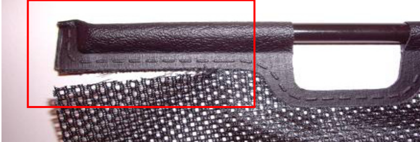
Fig. 138. Reprezentarea defectului rupere material în zona îmbinării sudate
