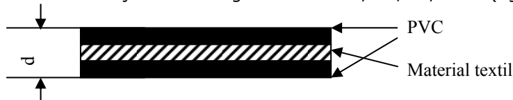
Fig. 32. Structura PVC cu inserție textilă
