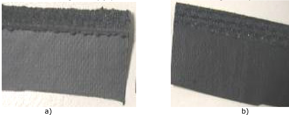
Fig.149. Poziția fibrei textile față de îmbinarea sudată
