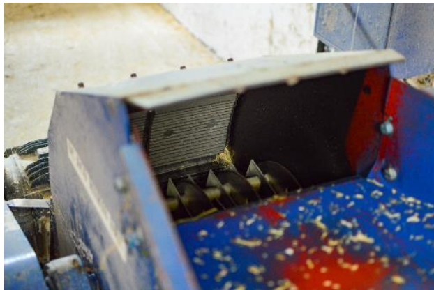
Figura 2.7 Detaliu de funcționare a morii cu ciocane
