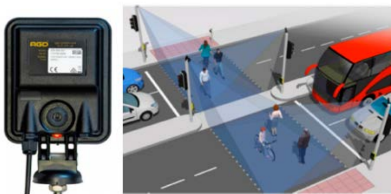
Figura 4.1.1. Radarul AGD326 este un detector de pietoni de 24 GHz care poate fi utilizat pentru optimizarea etapei de traversare. (Sursă imagine: www.agd-systems.com ; accesat la 30 octombrie 2021).
