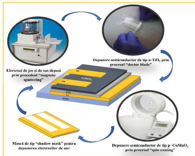
Figura 3.6. Schema de principiu a proceselor de depunere pentru realizarea dispozitivului heterojuncțional
