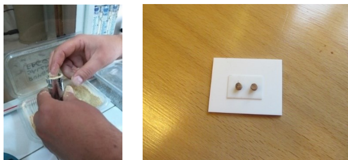
Fig. 5.15. Pelete pentru comportamentul de topire a cenușii, [arhiva proprie]
