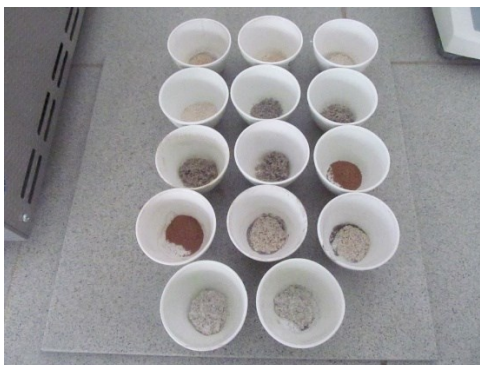
Fig. 5.13. Exemple de mostre după procesul de ardere, [arhiva proprie]
