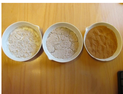
Fig. 5.14. Cenușă obținută pentru comportamentul de topire a cenușii, [arhiva proprie]
