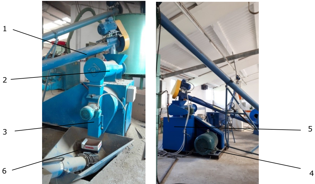
Fig. 3.14. Presa de peleți: 1- transportor elicoidal, 2-transportor elicoidal (alimentator), 3- dozator, 4-motor acționare presă, 5- corpul presei de peleți, 6-transportor elicoidal de peleți spre cernere uscare, [arhiva proprie]
