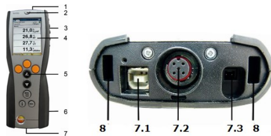
Fig. 5.29. Unitatea de control a gazoanalizorului TESTO 350 XXL: 1-interfața IrDA, 2-buton pornire/oprire, 3-suport magnetic, 4-display, 5-tastatura, 6-bara de contact pentru măsurători (pe spate), 7-interfețe: 7.1- USB 2-0, 7.3-încărcător, 7.2-TESTO DATA, 8-caneluri de ghidare pentru blocare cu unitatea de analiză, (după [169])
