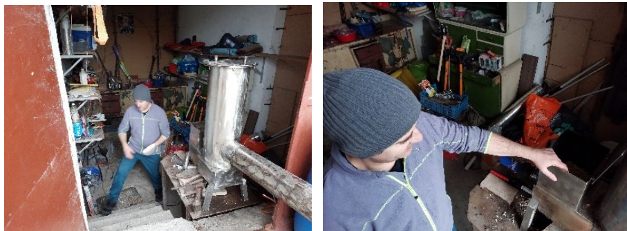
Fig. 4.18. Centrala termică pilot la primele probe de ardere a peșteilor, [arhiva proprie]
