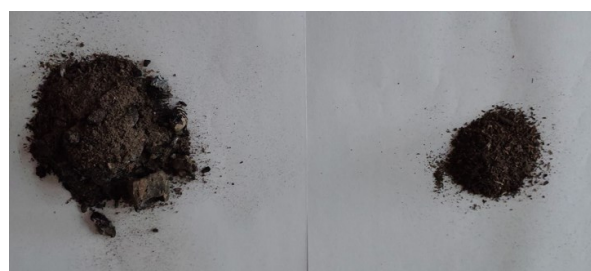
Fig. 5.40. Cenușa rezultată în urma arderii probei P1: a) din focar, b) din colectorul de cenușă zburătoare, [arhiva proprie]
