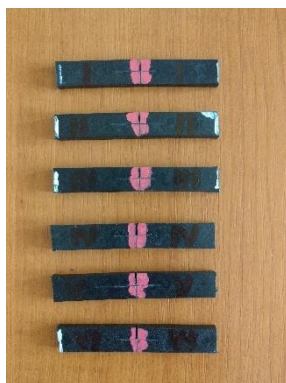
Fig. 3.16. Probele pregătite pentru investigațiile statice ale tenacității la rupere.
