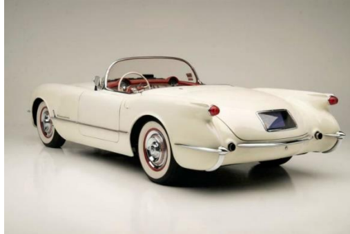
Fig. 1.1. Modelul Chevrolet Corvette C1 având caroseria dintr-un material compozit.
