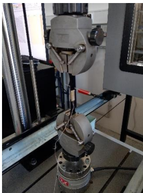
Fig. 4.10. Măsurarea temperaturii probei în timpul încercărilor la oboseală: a) termocuplul folosit; b) temperatura înregistrată.
