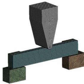
Fig. 5.7. Model de elemente finite utilizat pentru simulări – mesh solid folosind elemente hexaedrice.
