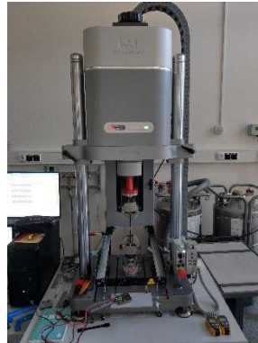
Fig. 4.9. Instron Electropuls E300 folosit în cadrul încercărilor la oboseală.
