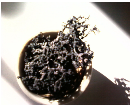
Figura 3.40. Imaginea pulberii obținute în urma calcinării gelului la 500°C
