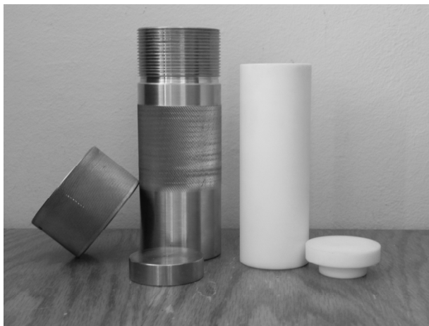
Figura 2.4. Autoclavă de teflon prevăzută cu manta de oțel
