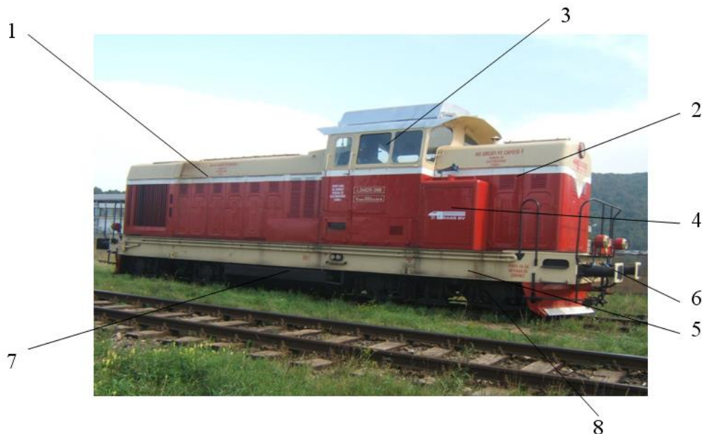
Figura 4.17. Locomotiva LDH 125: 1- capota mare a locomotivei unde se află motorul diesel 6 LDA 28 B; 2 - capota mică a locomotivei unde se află agregatul de încălzire al trenului remorcat; 3 - cabina mecanicului și ajutorului de mecanic al locomotivei în care se găsesc două pupitre de comandă ale locomotivei; 4 - compresorul locomotivei; 5 - lonjeronul locomotivei care susține partea superioară a locomotivei și care face legătura cu aparatul de rulare; 6 - aparatele de ciocnire și legare ale locomotivei; 7 - rezervorul principal al locomotivei; 8 - aparatul de rulare al locomotivei.
