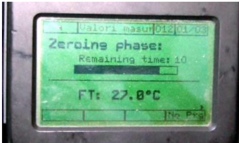
Figura 4.40. Screenshot ce indică momentul de calibrarea la zero a analizorului.
