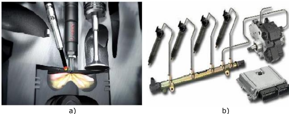
Figura 3.4. Injector fin acționat de sistem common-rail [17, 119]
