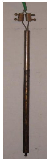
Figura 4.25. Termocuplul pentru măsurarea temperaturii gazelor de evacuare
