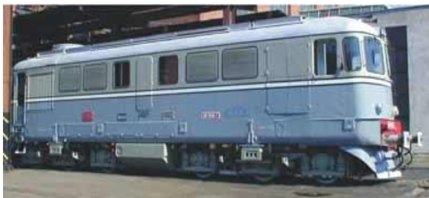
Figura 1.10. Locomotiva diesel-electrică românească 060-DA
