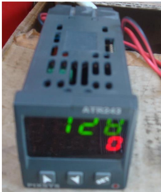
Figura 4.28. Exemplu de vizualizare a temperaturilor cu convertorul Pixsys ATR 243 ABC.
