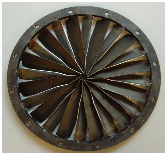
Figura 4.15. Post mixer al gazelor de ardere cu soluția de AdBlue
