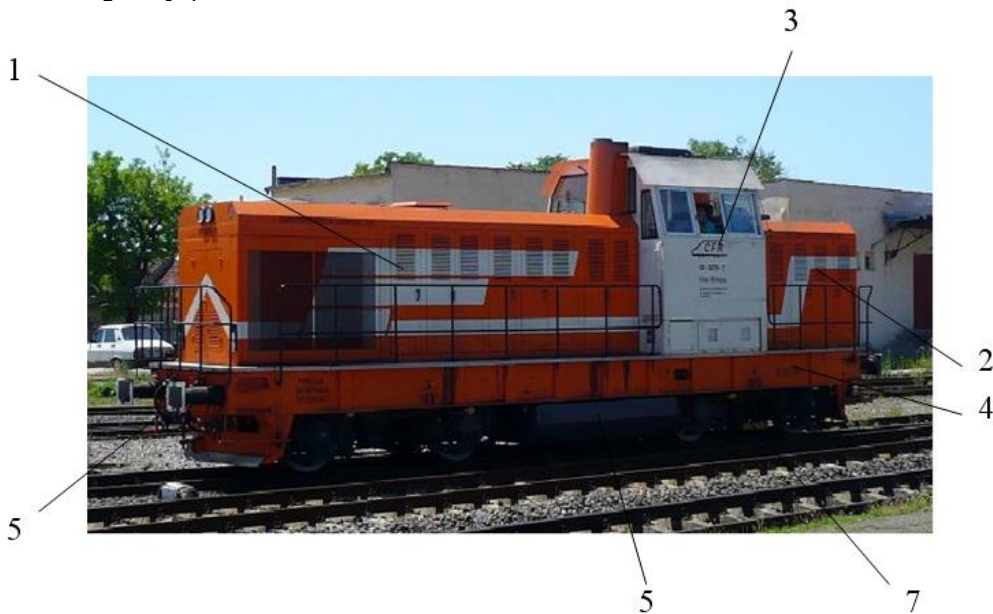
Figura 4.20. Locomotiva LDH de 1360 CP: 1- capota mare a locomotivei unde se află motorul diesel Caterpillar 3508 B; 2 - capota mică a locomotivei unde se află grupul electrogen de încălzire al trenului remorcat; 3 - cabina mecanicului și ajutorului de mecanic al locomotivei în care se găsesc două pupitre de comandă ale locomotivei; 4 - lonjeronul locomotivei care susține partea superioară a locomotivei și care face legătura cu aparatul de rulare; 5 - aparatele de ciocnire și legare a locomotivei; 6 - rezervorul principal al locomotivei; 7 - aparatul de rulare al locomotivei.
