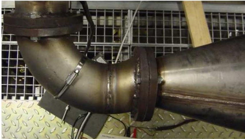
Figura 4.8. Configurația sistemului de evacuare înainte catalizatorului DOC
