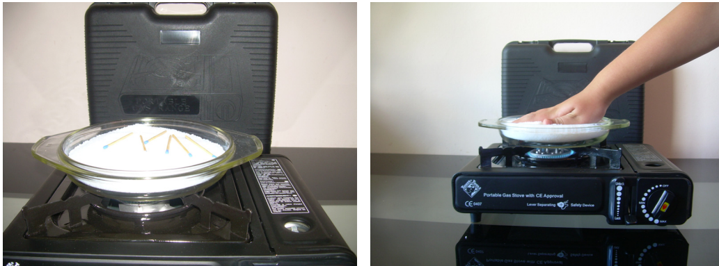
Fig.6.10. Aerogelul granulat nu este inflamabil și rezistă la temperaturi foarte înalte
