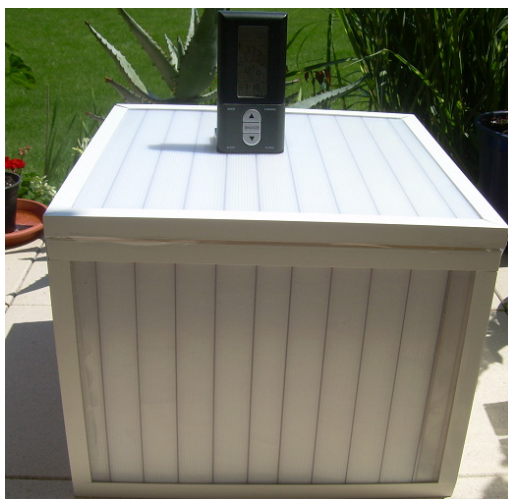
Fig.6.39. Studiu termic cub cu nanogel încorporat
