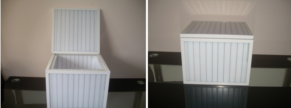
Fig.6.25. Cub din panouri celulare de policarbonat cu nanogel alb opac încorporat
