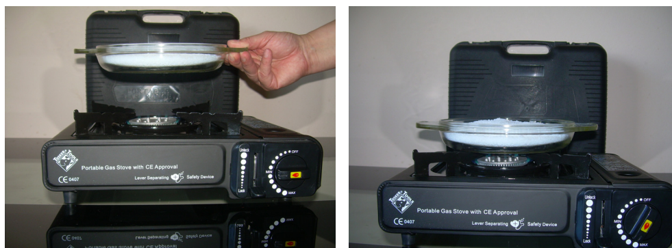
Fig.6.9. Aerogelul granulat nu este inflamabil și rezistă la temperaturi foarte înalte
