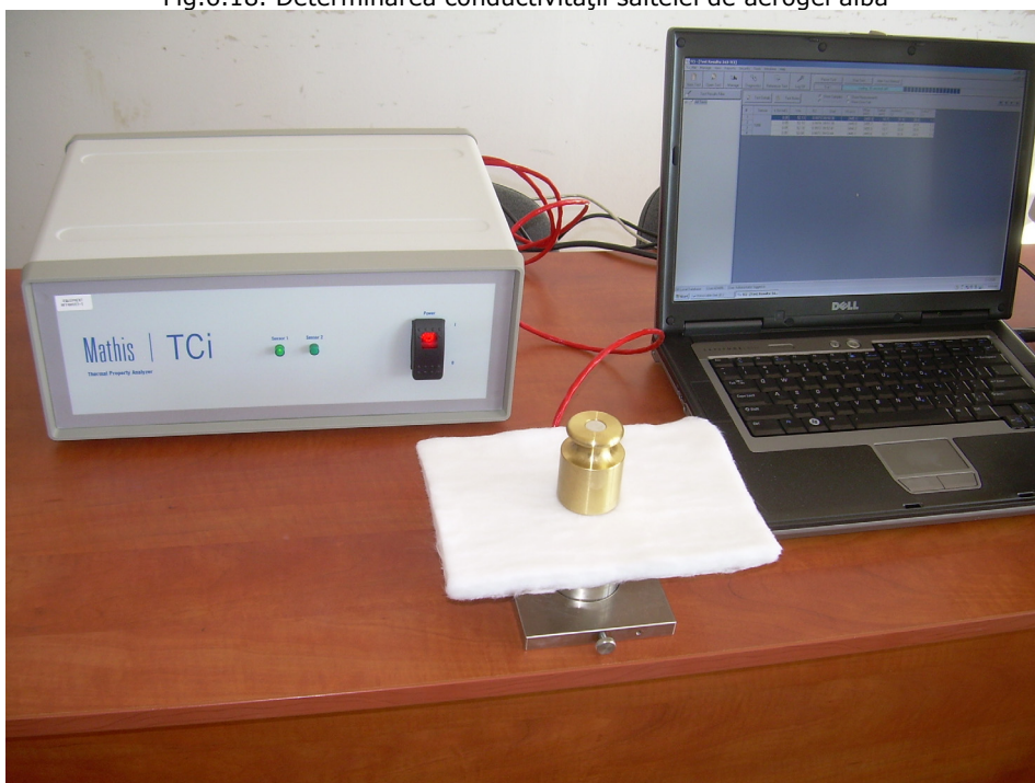
Fig.6.19. Determinarea conductivității saltelei de aerogel albă
