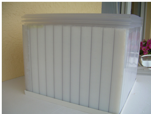
Fig.6.34. Umplerea cubului cu nanogel granulat alb opac și compactarea
