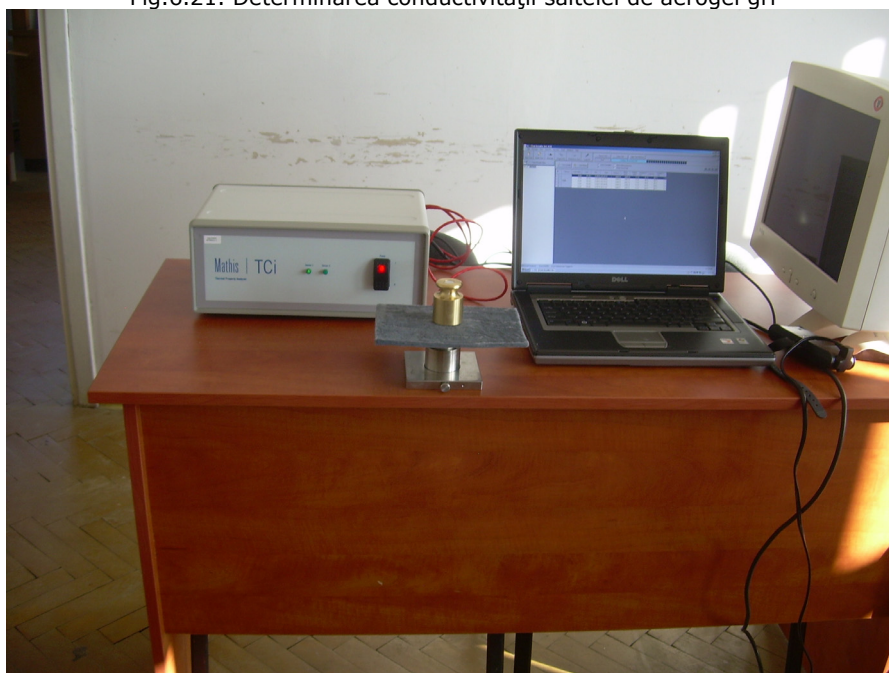
Fig.6.22. Determinarea conductivității saltelei de aerogel gri
