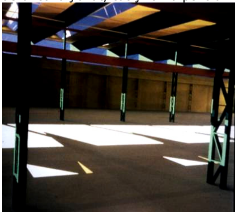
Fig.6.54. Sticla obișnuită conduce la zone supraluminate și zone umbrite
