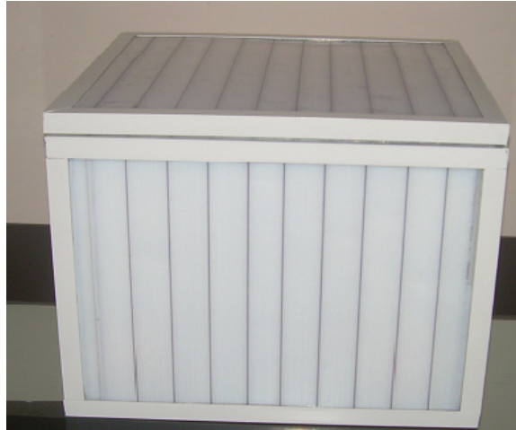
Fig.6.40. Studiu termic cub cu nanogel încorporat
