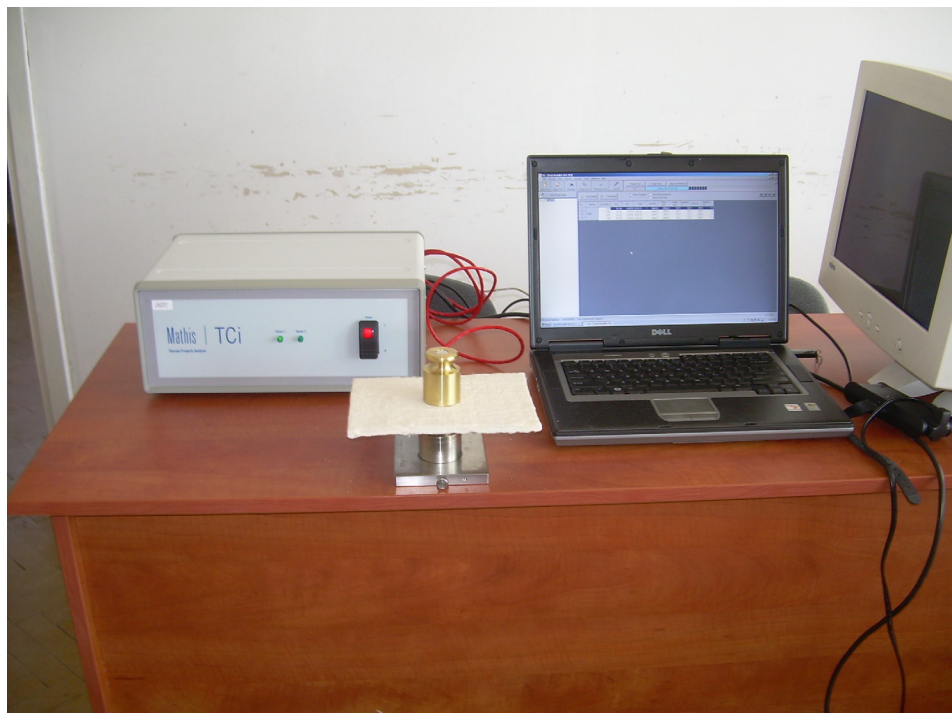
Fig.6.13. Determinarea conductivității saltelei de aerogel bej
