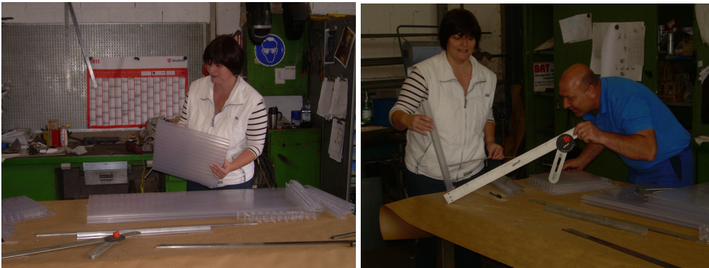
Fig.8.2. Trasarea panoului din policarbonat pentru confecționarea cubului
