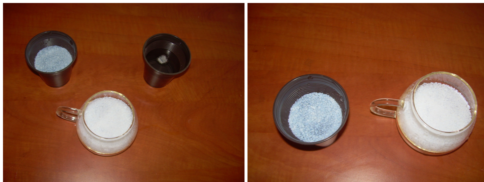
Fig.6.7. Aerogelul granulat este hidrofob, iar cel compact hidofil
