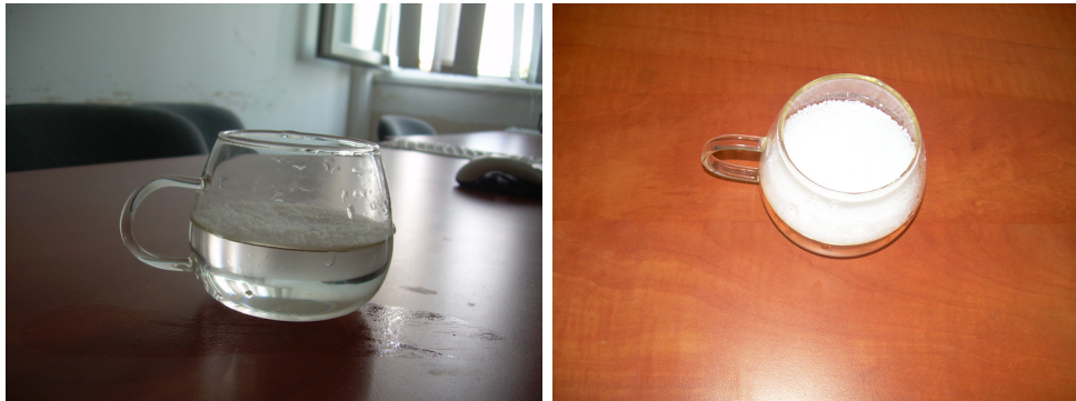
Fig.6.6. Aerogelul granulat este hidrofob
