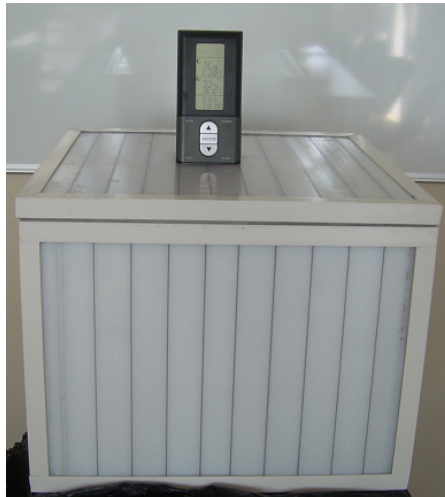
Fig.6.38. Studiu termic cub cu nanogel încorporat
