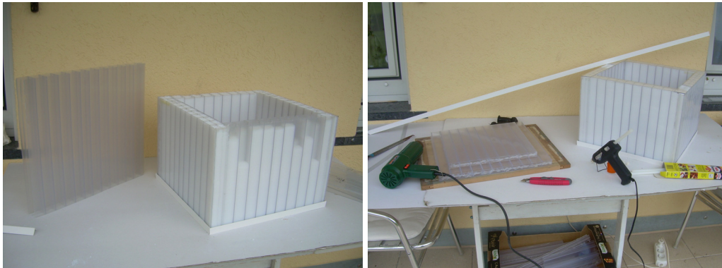
Fig.8.7. Umplerea cubului cu nanogel granulat alb, opac
