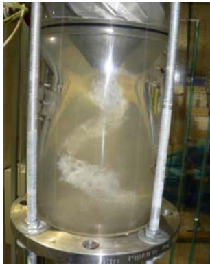
Figura 5. 30. Zona de stagnare în jurul căreia se formează vârtejul funie conform teoriei lui Nishi [90]
