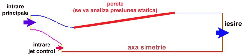
Figura 5. 18. Analiza presiunii de pe peretele secțiunii divergente corespunzătoare celor patru nivele de măsură de pe secțiunea de test
