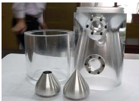
Figura 2. 23 Prelucrarea mecanică a secțiunii convergent-divergente (stânga) și forma finală a secțiunii cilindrice, a secțiunii convergent-divergente și a duzei de injecție (dreapta)
