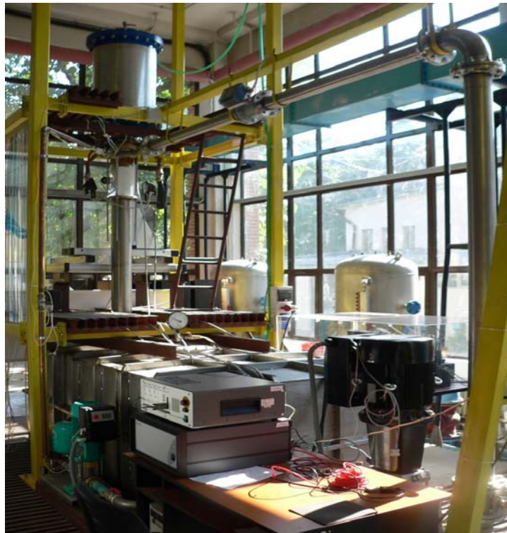
Figura 2. 1. Standul experimental proiectat, dezvoltat și executat pentru investigarea curgerii cu vârtej și cu injecție de apă, schița standului experimental (sus) și vedere laterală (jos)
