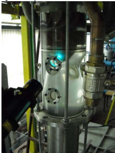
Figura 3. 4. Măsurarea unui profil de viteze în secțiunea convergentă (stanga) și coordonatele 3D de început și sfârșit pentru fiecare fereastra în parte inserate în softul de deplasare al traverselor (dreapta)
