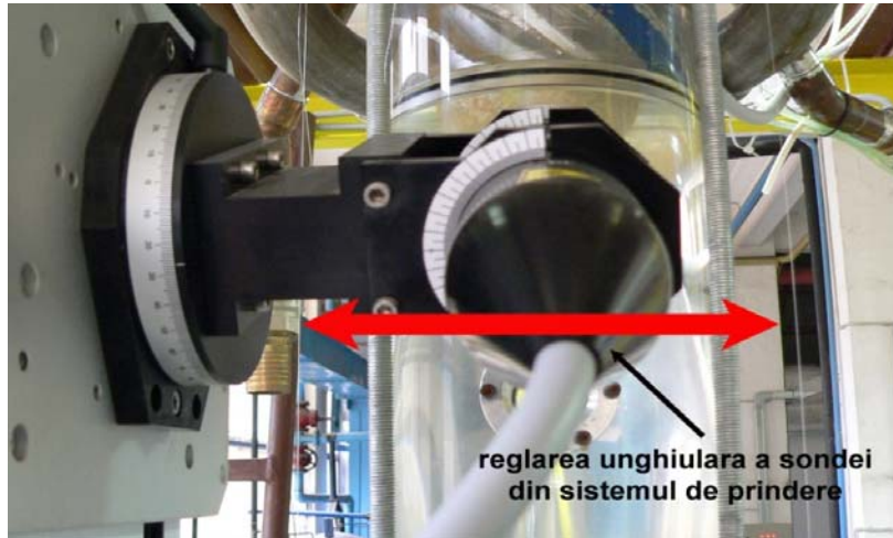
Figura 3. 8. Reglarea unghiulară a sondei față de secțiunea de test
