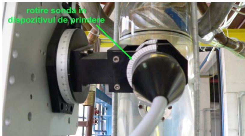
Figura 3. 9. Reglarea sondei la unghiul de rotație potrivit
