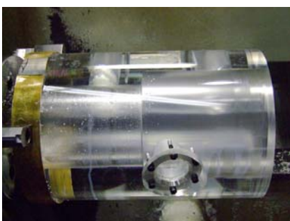
Figura 2. 23 Prelucrarea mecanică a secțiunii convergent-divergente (stânga) și forma finală a secțiunii cilindrice, a secțiunii convergent-divergente și a duzei de injecție (dreapta)
