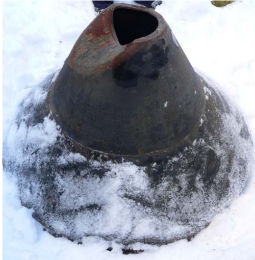
Figura 1. 6. Efectele vârtejului funie, fisuri ale paletelor (stânga-sus), ruperi ale paletelor (dreapta-sus), smulgerea ogivei de pe coroana rotorului (jos), Frunzăverde et al [44].
