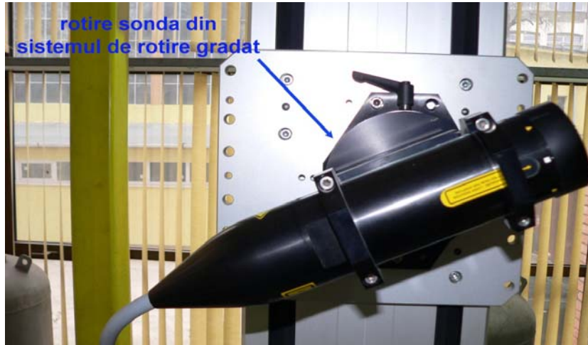
Figura 3. 10. Reglarea sondei la înclinarea corespunzătoare
