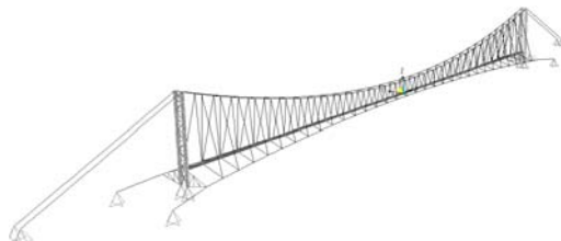
Fig. 7.8. Traversare suspendată modelată în SAP2000
