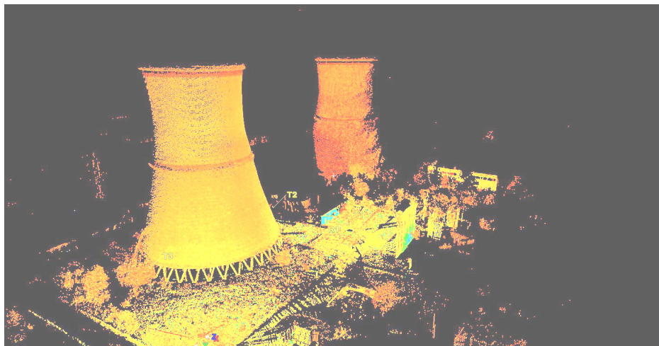
Fig. 6.1. Modelul 3D scanat al turnului de răcire nr.1
