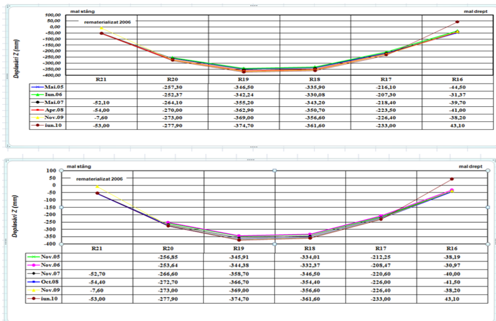
Diagrama 9 - Evoluția deplasărilor pe verticală a reperilor R21-R20-R19-R18-R17-R16
