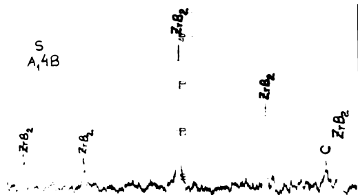
Fig.10.40.Spectrul de difracție a masei SA14B reacționată.
