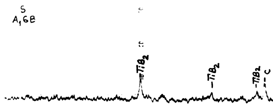
Fig.10.39.Spectrul de difracție a masei SA16B reacționată.
