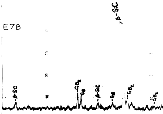
Fig.10.34.Spectrul de difracție a CrB_2 , obținută în cuptorul de SiC (după îndepărtarea grafitului).
