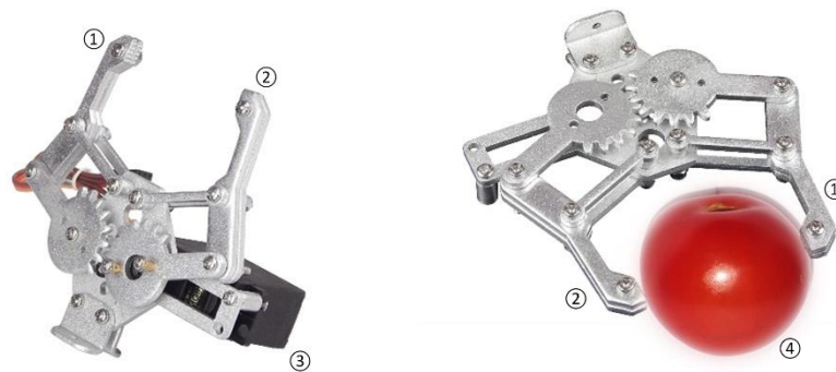
Figura 4.6 Prehensor pentru servomotoare MG995 (1 – brațul stâng, 2 – brațul drept, 3 – servomotor, 4 – roșie)
