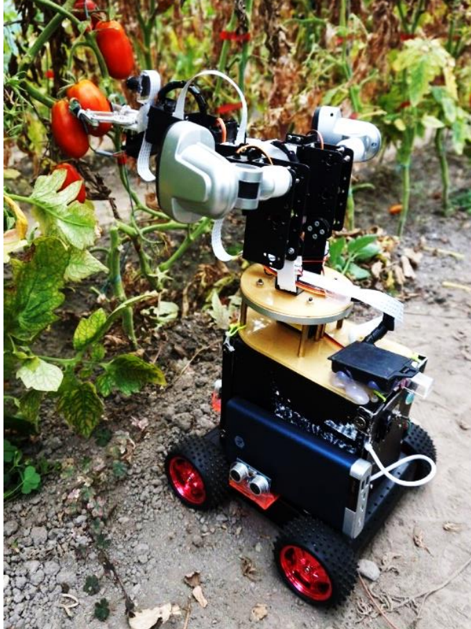
Figura 7.22 Procesul de prindere a roșiei
