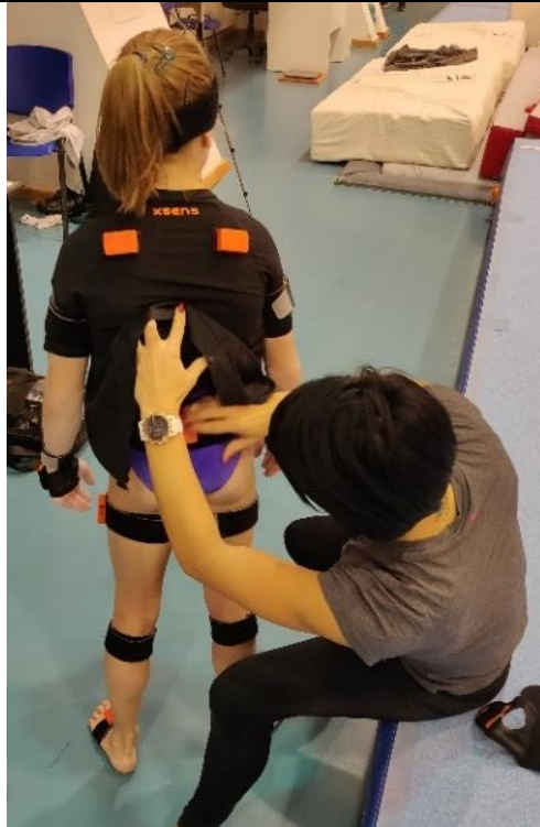
Fig. 4.19 Montarea senzorilor cu ajutorul curelelor Awinda pe costumul lycra
