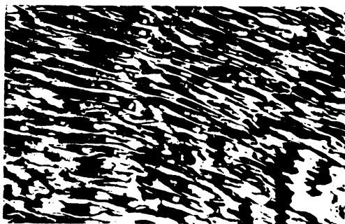
Atac: Apă regală; 1000:1 Fig. 4.20. Microstructura stratului de InterAlloy IWE, după ecrusare prin lovire
