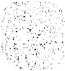
Fig.4.11. Amprenta Baumann pentru determinarea repartiției sulfurilor în secțiunea oțelului MoCN15 Scara: 1:1
