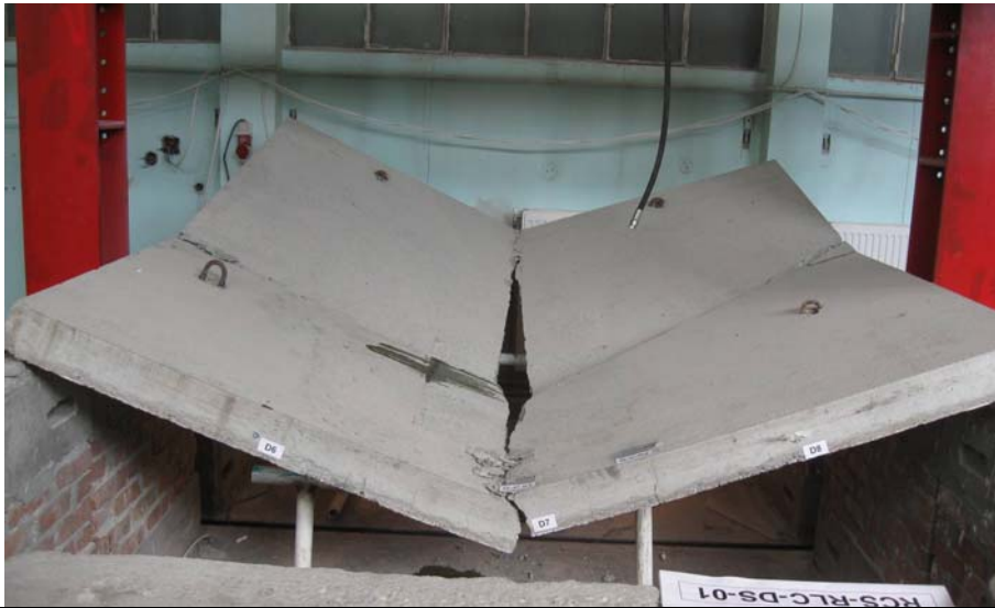
Fig. 6.71. - Starea plăcii la finalul încercării
