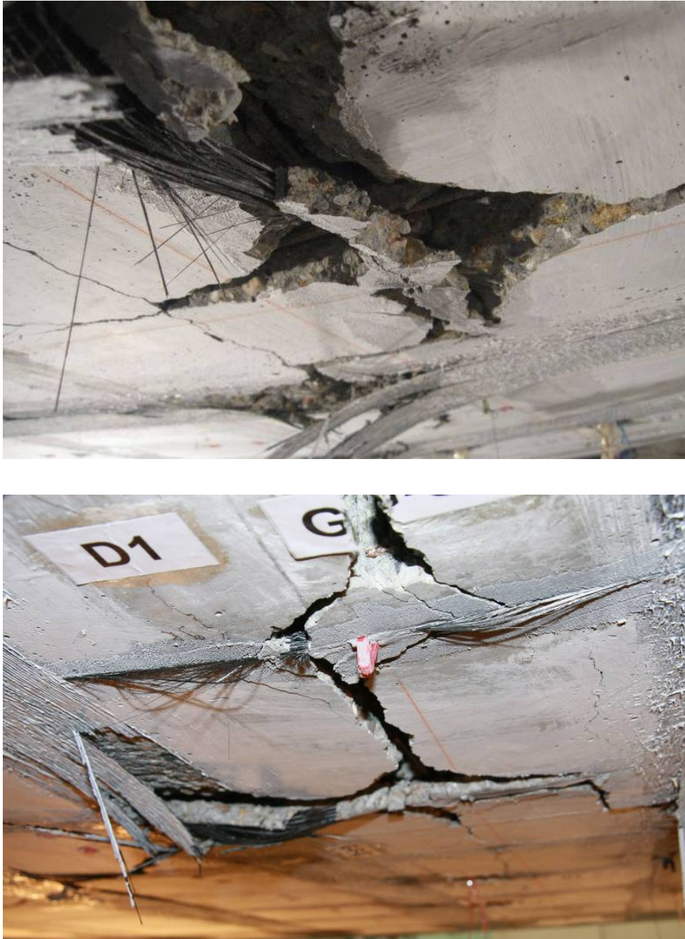
Fig. 6.41. - Detalii de cedare ale benzilor (NSMR)
