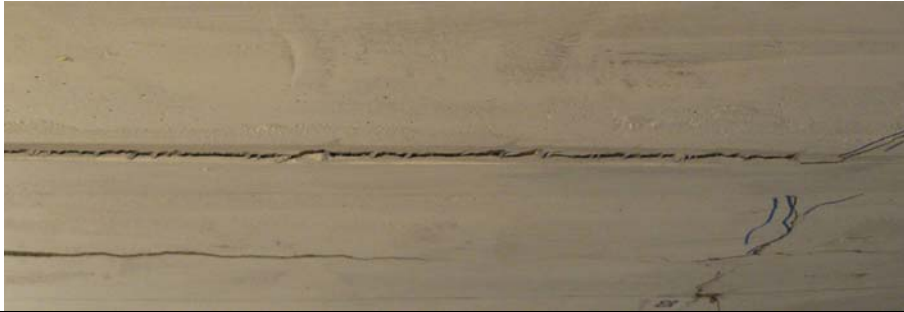
Fig. 6.56. - Inițierea cedării prin pierderea aderenței lamelei
