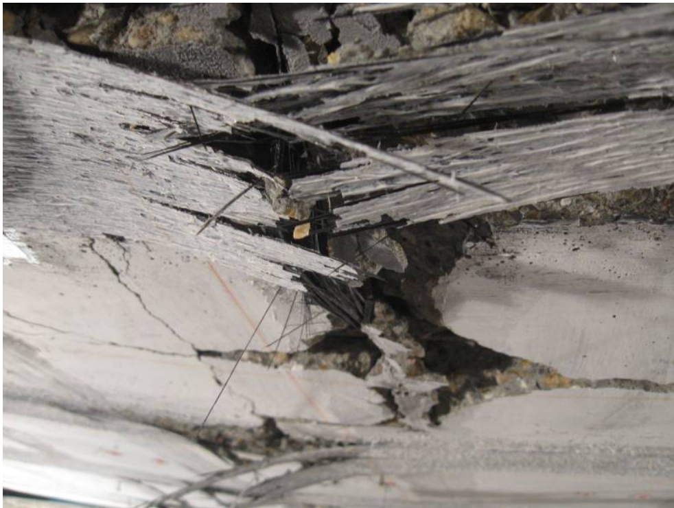
Fig. 6.42. - Detalii de cedare în zone de intersecție bandă (NSMR) - fâșie (EB)
