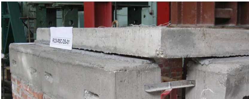
Fig. 6.59. - Ridicarea colțurilor plăcii sub efectul încărcărilor aplicate
