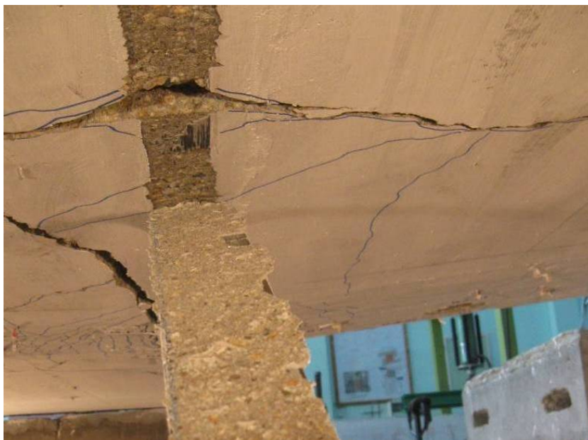
Fig. 6.55. - Cedarea prin pierderea aderenței a lamelei montate prin EB-FRP
