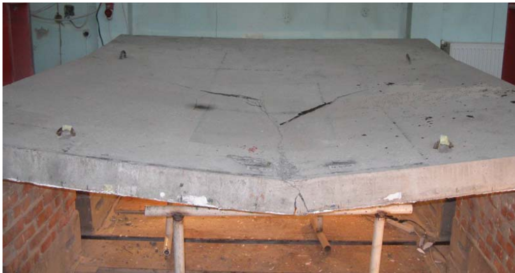
Fig. 6.83. - Vedere a suprafeței superioare a plăcii la finalul încercării
