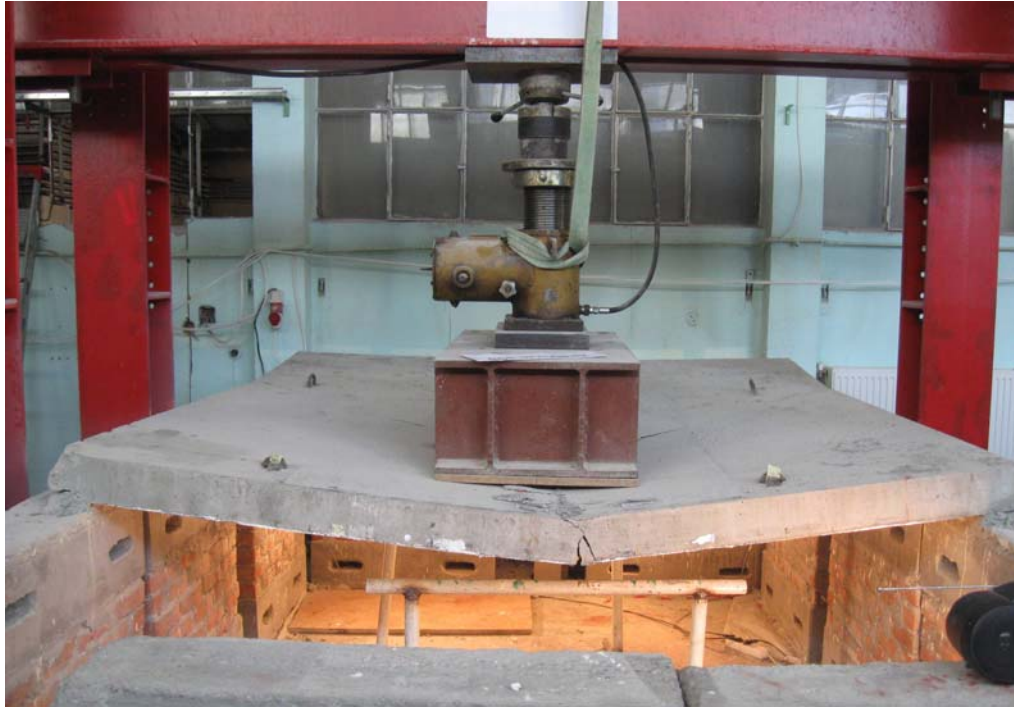
Fig. 6.82. - Starea plăcii la finalul încercării
