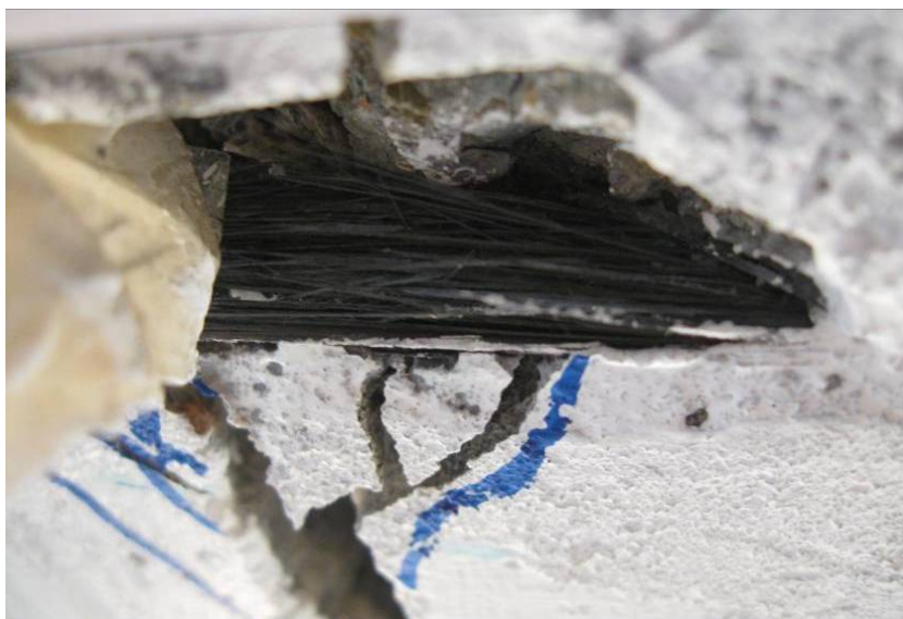
Fig. 6.54. - Detaliu de cedare a unei benzi montate în șliț
