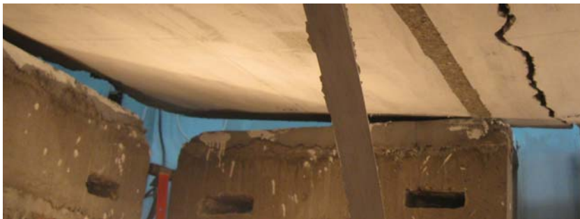
Fig. 6.58. - Ruperea unei bare de armătură într-o zonă de nod a plasei inferioare
