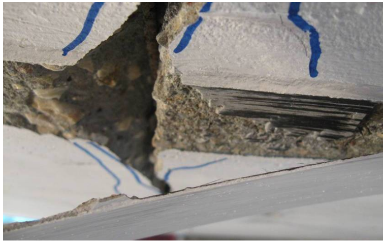
Fig. 6.56. - Inițierea cedării prin pierderea aderenței lamelei
