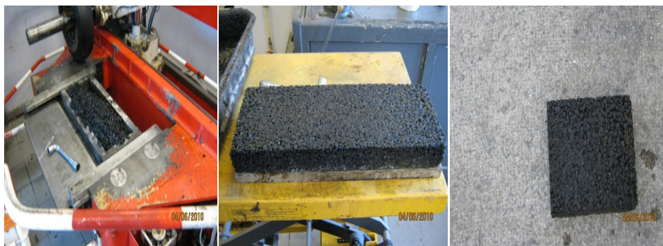
Figura 3.26. Realizarea probelor de mixtură asfaltică cu cenușă de termocentrală
