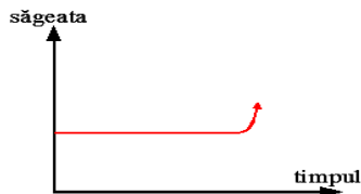
Figura 2.15. Evoluția deformației în încercarea cu efort constant
