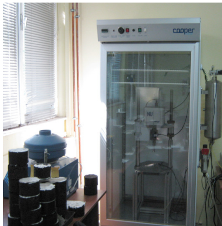
Figura 4.36. Camera și aparatul de testare COOPER CRT-NU14
