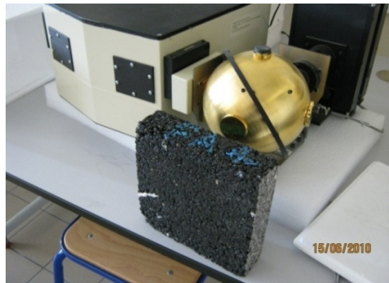
Figura 3.35. Determinarea emisivității pe amestecurile asfaltice în cadrul laboratorului din instituția gazdă
