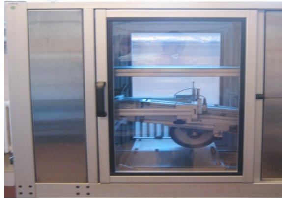
Figura 4.58. Aparatul pentru ornieraj (făgășuire)
