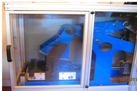
Figura 4.6. Rulou compactor pentru plăci
