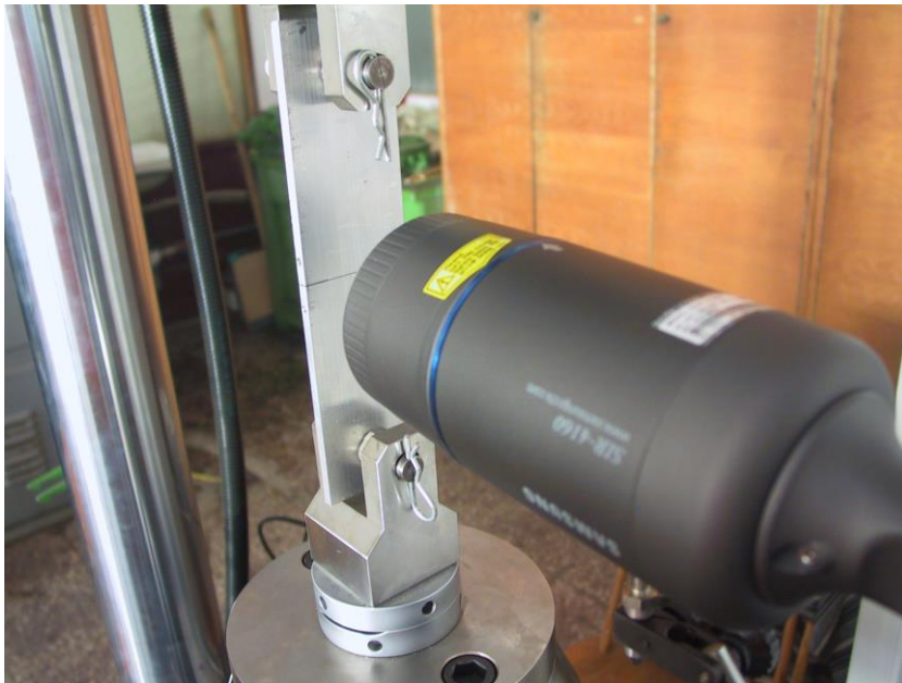
Fig.4.11. Amplasarea camerei video în lateralul epruvetei
