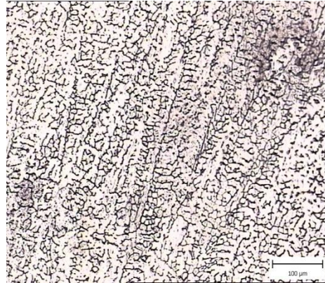
Fig.4.35 Imagine micrografică, metal sudură, probă sudată MIG, oțel X5CrNi18-10, X100
