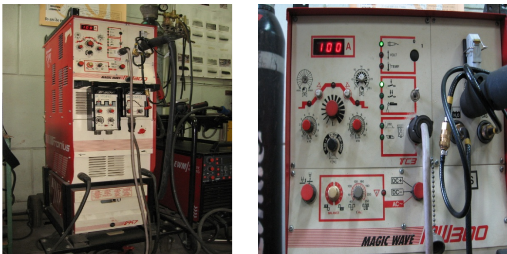
Fig.3.1 Instalație de sudare WIG, MAGIC WAVE 300
