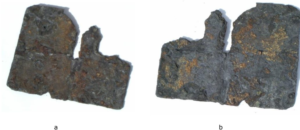
Fig.4.45 Aspectul probelor sudate din oțel inoxidabil X10CrNi18-10/AISI 304, în urma expunerii în mediul coroziv rezultat din incinerarea deșeurilor speciale, a-fața probei sudate, b-dosul probei.
