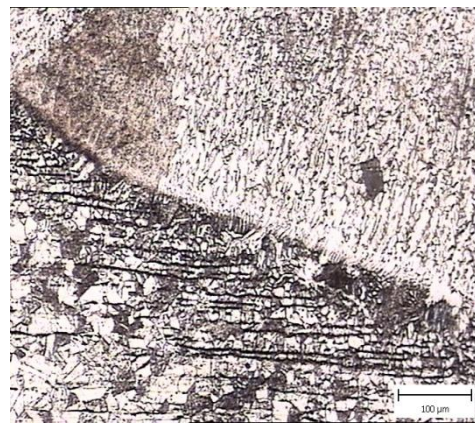
Fig.4.33 Imagine micrografică, zona de trecere, probă sudată MIG oțel X5CrNi18-10, X100
