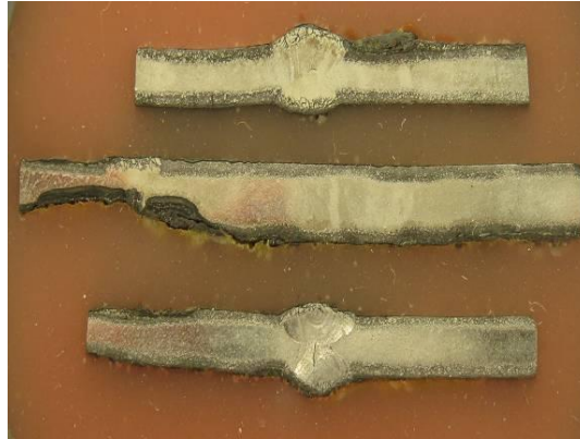
Fig.4.52 Macrografie îmbinări sudate, Inconel 601, s=4mm, după expunere 36 zile în mediu coroziv rezultat din incinerarea deșeurilor speciale
