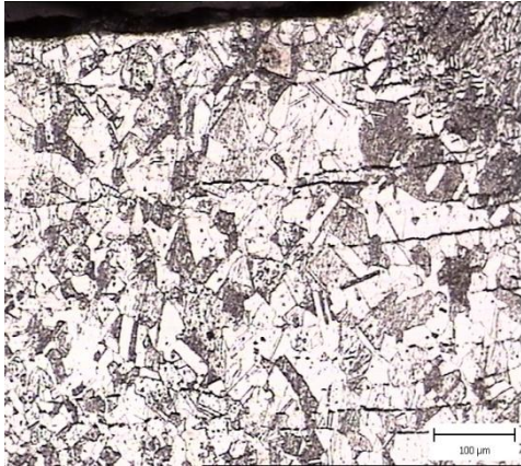
Fig.4.37 Imagine micrografică, zona de influență termică, probă sudată WIG, oțel X5CrNi18-10, X100
