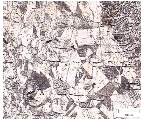
Fig.4.31 Imagine micrografică, zona influențată termic, probă sudată MIG oțel X5CrNi18-10, X100
