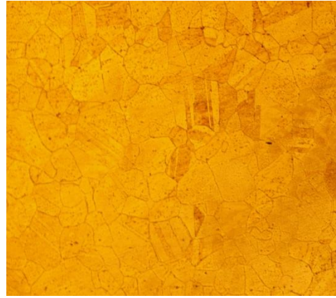
Fig.4.80 Imagine micrografică, metal de bază, zona centrală, Inconel 601, s=4 mm, X100
