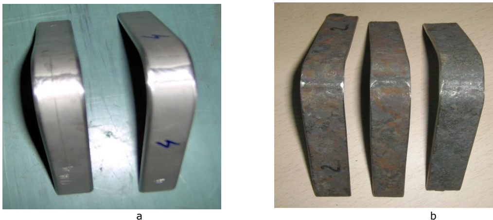
Fig.4.11 Imagini ale epruvetelor încercate la îndoire frontală din aliaje de nichel a-înainte de supunerea în mediu coroziv, b-după acțiunea mediului coroziv rezultat din arderea deșeurilor speciale
