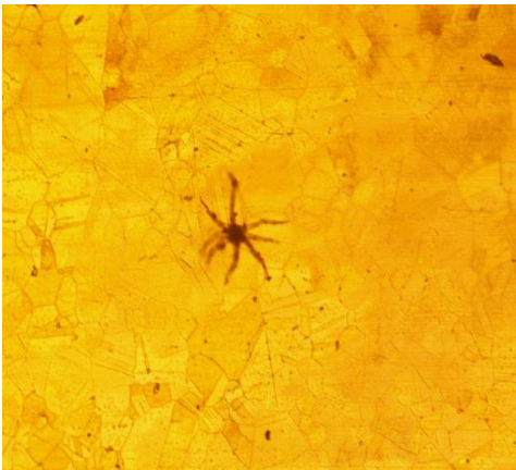
Fig.4.81 Imagine micrografică, metal de bază, zona centrală, Inconel 601, s=4 mm, X100
