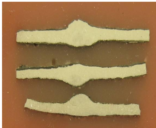
Fig.4.51 Macrografie îmbinări sudate, Inconel 601, s=3mm, după expunere 36 zile, în mediul coroziv rezultat din incinerarea deșeurilor speciale
