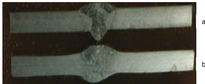
Fig.4.28 Macrografie îmbinări sudate, oțel X5CrNi18-10, s=4mm, sudate WIG a-stare inițială, b-după expunere în mediu coroziv
