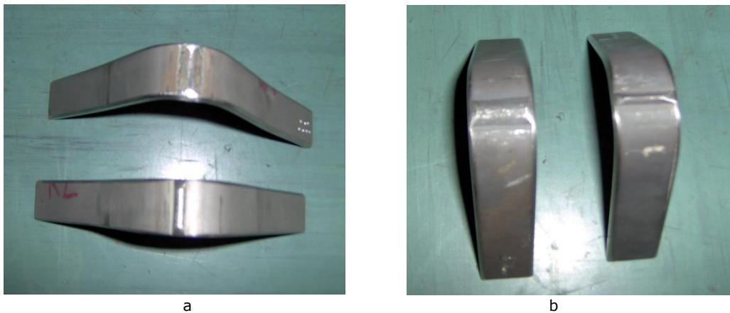
Fig.4.10 Imagini ale epruvetelor încercate la îndoire frontală din oțel inoxidabil a-înainte de supunerea în mediu coroziv, b-după acțiunea mediului coroziv rezultat din arderea amestecului biomasă-carbune
