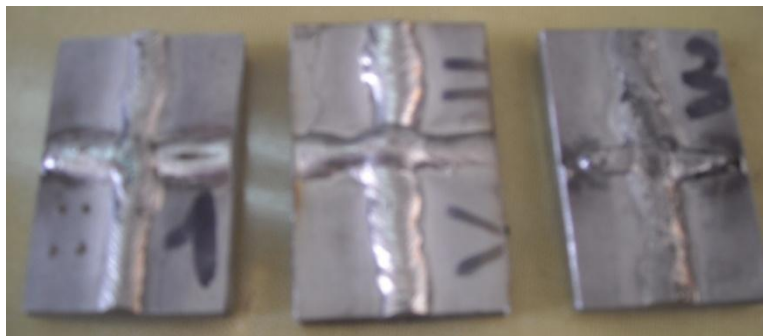
Fig.4.6 Imagini de epruvete pentru încercarea la coroziune intercristalină, prelevate din probele sudate
