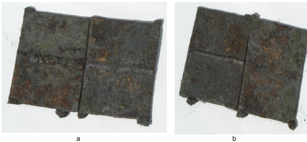
Fig.4.47 Aspectul probelor sudate din Inconel 625/N06625, în urma expunerii în mediul coroziv rezultat din incinerarea deșeurilor speciale, a-fața probei sudate, b-dosul probei
