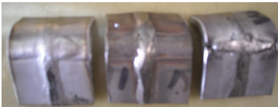
Fig. 4.25 Epruvete prelevate din îmbinări sudate din aliaje de nichel, înainte de introducerea în mediul coroziv
