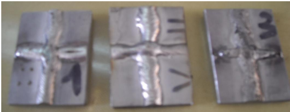
Fig.4.23 Epruvete pentru încercarea la coroziune intercrystalină, prelevate din probele sudate
