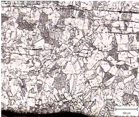
Fig.4.30 Imagine micrografică, zona influențată termic, probă sudată WIG oțel X5CrNi18-10, X100
