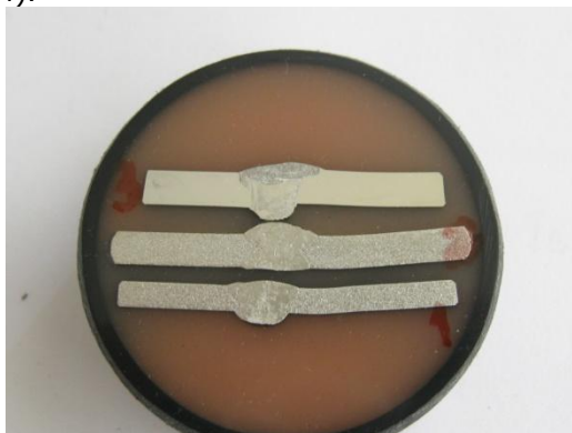
Fig.4.4 Epruvete din aliaje de nichel, pentru incercarea de microduritate
