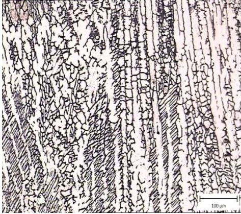
Fig.4.41 Imagine micrografică, metal sudură probă sudată WIG, oțel X5CrNi18-10, X100
