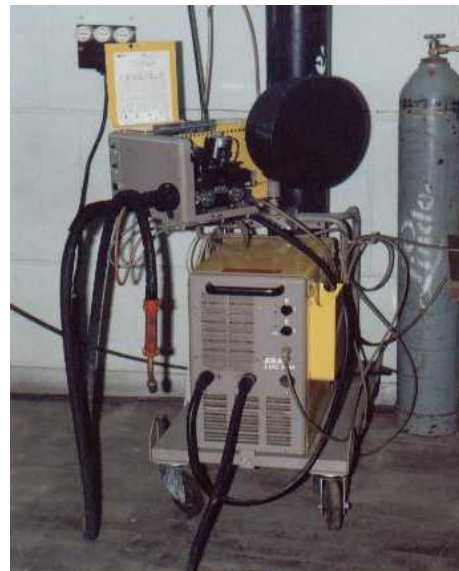
Fig.3.2 Instalație de sudare MIG, LUC 500-ARISTO, ESAB
