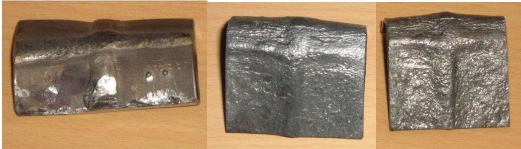
Fig. 4.26 Epruvete prelevate din îmbinări sudate din aliaje de nichel, supuse mediului coroziv rezultat din incinerarea deșeurilor speciale
