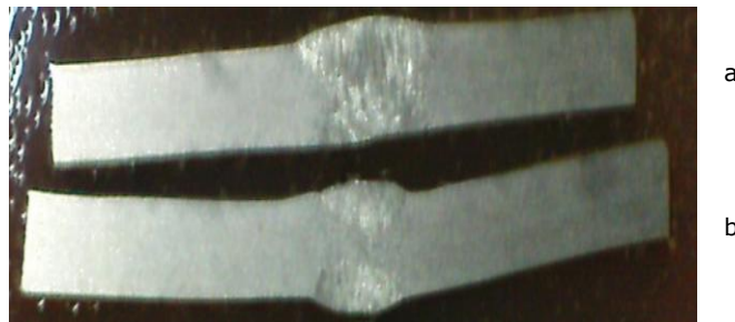
Fig.4.27 Macrografie îmbinări sudate, oțel X5CrNi18-10, s=4mm, sudate MIG a-stare inițială, b-după expunere în mediu coroziv
