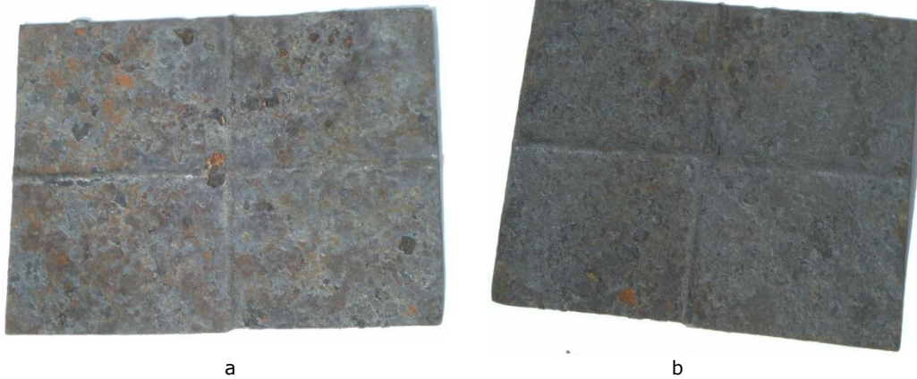
Fig.4.46 Aspectul probelor sudate din Inconel 601/N06601, în urma expunerii în mediul coroziv rezultat din incinerarea deșeurilor speciale, a - fața probei sudate, b - dosul probei .
