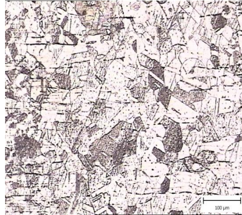
Fig.4.38 Imagine micrografică, zona de influență termică, probă sudată MIG oțel X5CrNi18-10, X100
