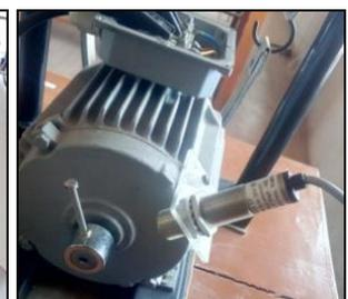
Fig. 22. Speed sensor.
