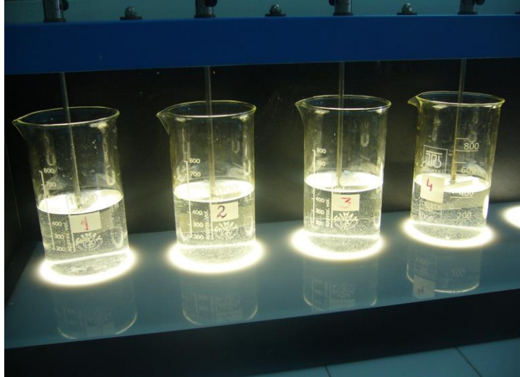
Fig. 7.28 Imagine a procesului de coagulare prin metoda Jar-test utilizând PAC
