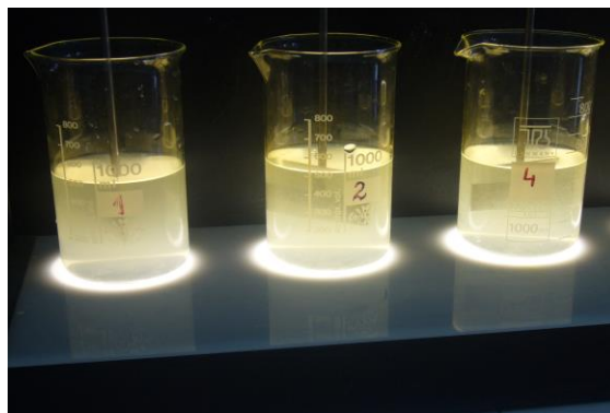
Fig. 7.27 Imagine a procesului de coagulare prin metoda Jar-test utilizând SA
