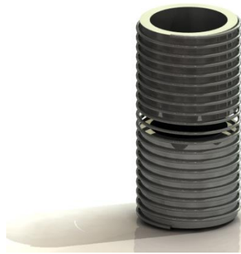
c. solenoid cu miez feromagnetic cu apertură pentru amplificarea câmpului magnetic
