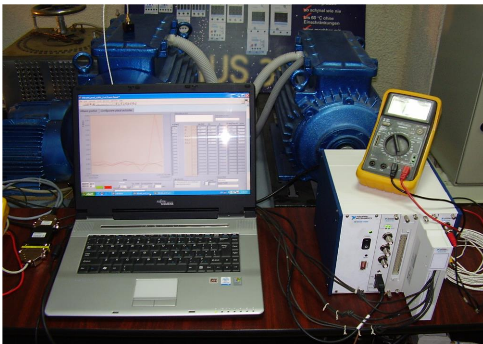
Fig. 5.8 Stand de probă pentru determinare vibrații și vibropercuții
