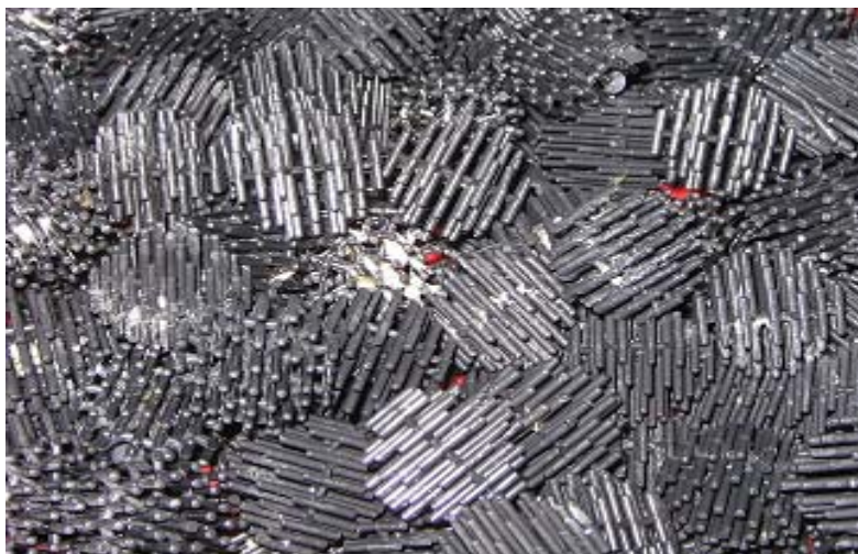
Figura 6.2 Materiale care asigură suportul dezvoltării biomasei
