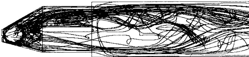
Figura 7.42: Traiectoriile particulelor în tubul de aspirație al turbinei Kaplan pentru punctul de funcționare GP17
