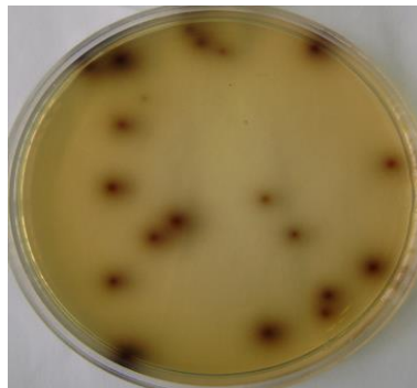
Figura 6.18. Imaginea foto a plăcilor Petri pentru evidențierea acțiunii bactericide 0,05 g pentru Z-TiO 2 FH la TI 60 minute
