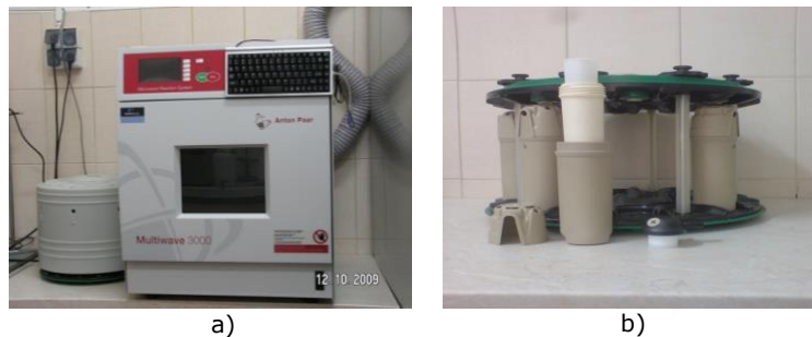
Figura 4.1. Cuptorul cu microunde utilizat în sinteza \text{TiO}_2 prin MHMW (a); autoclave utilizate în sinteza \text{TiO}_2 prin MHMW (b)
