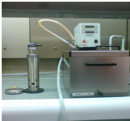
Figura 4.2. Instalație utilizată în sinteza \text{TiO}_2 prin metoda FH
