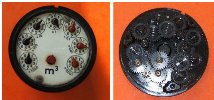
Fig.5.16. Realizarea practică a mecanismului reductor-integrator sub forma unui tren de roți dințate
