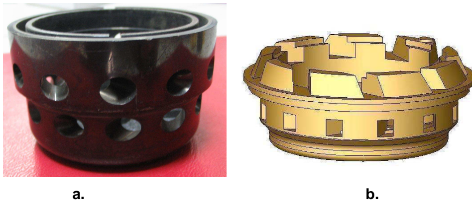
Fig. 4.17. Canale de intrare și ieșire: a-cilindrice, b-dreptunghiulare
