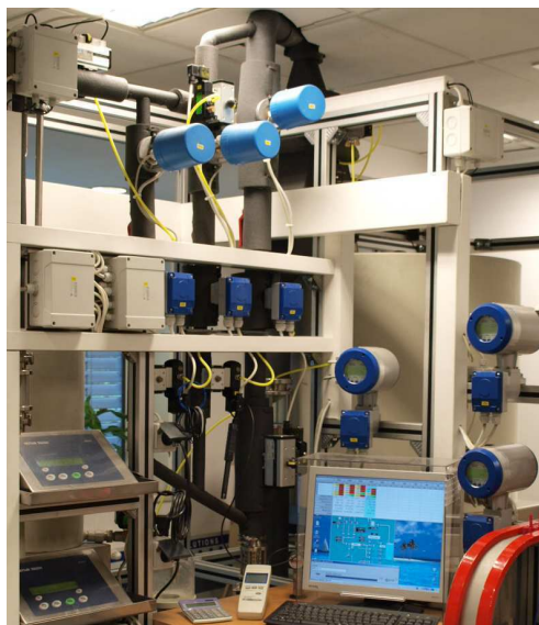
Fig.6.5. Blocul de reglare a standului de verificare
