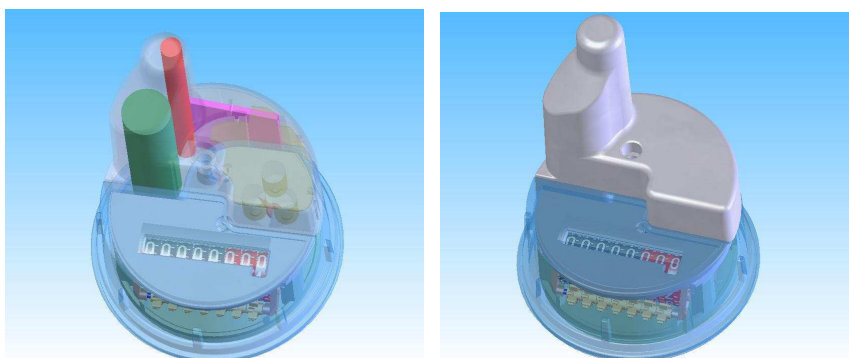
Fig.5.49. Soluție constructivă de modul radio compact
