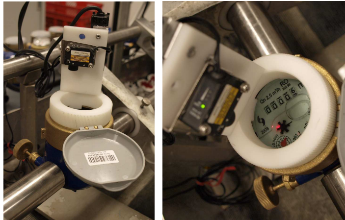
Fig.6.7. Modul de preluare a impulsurilor optice de la contor
