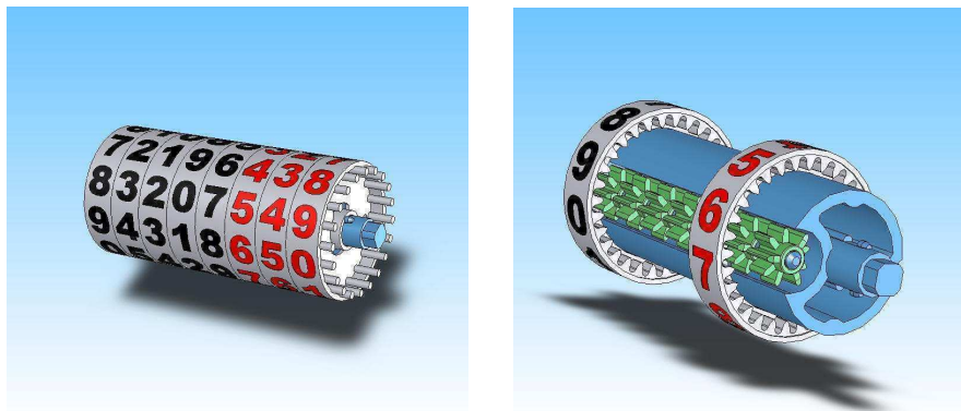
Fig.5.38. Mecanism integrator compact format din celule de comutare cu pinioane de comutare amplasate în interior
