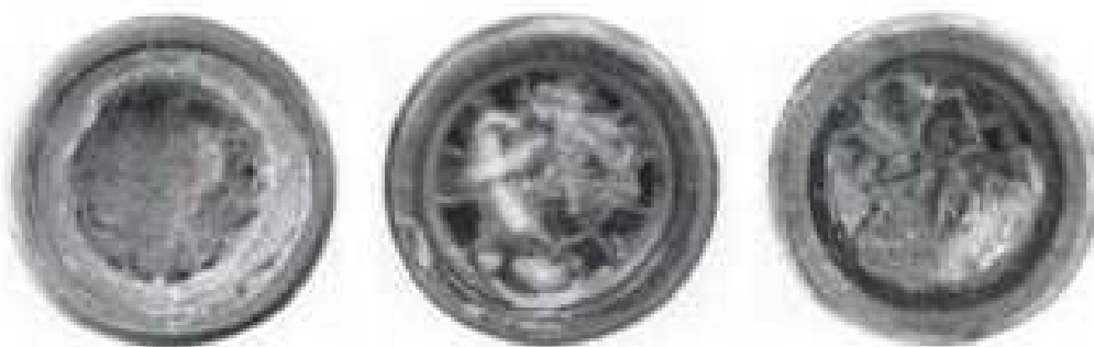
Fig.3.5. Site obturate prelevate de la contoare monojet din exploatare [5]
