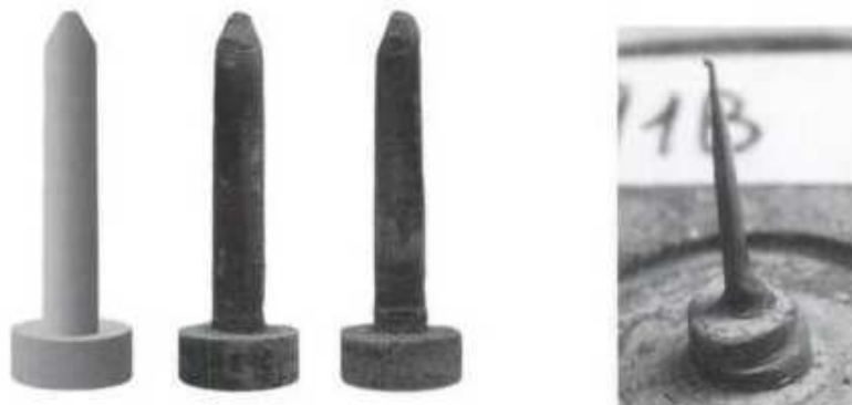
Fig.3.2. Stifturi lașăr inferioare uzate datorită unei montări improprii a contorului monojet [5]
