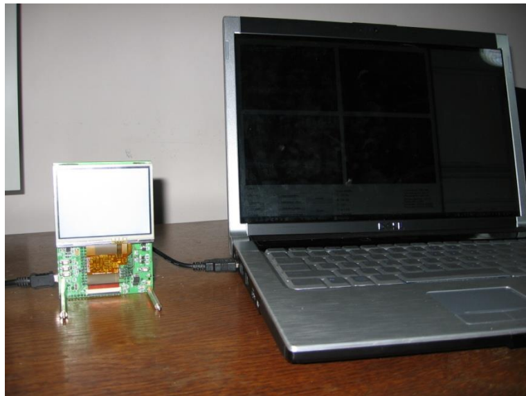
Figura 5.2 Placă de dezvoltare bazată pe microprocesorul ISAAC
