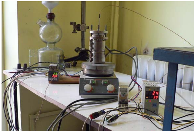
Fig. 7.2.2. Instalația folosită pentru experimentele hidrotermale.
