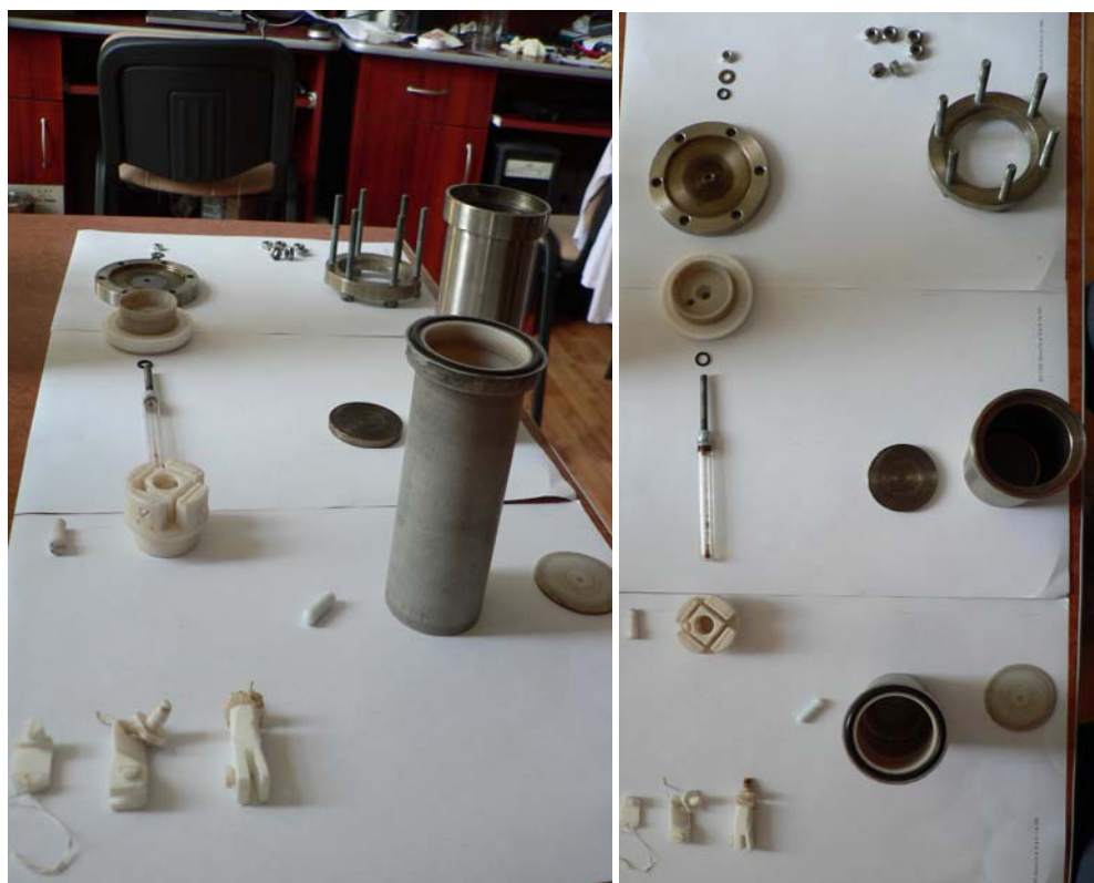
Fig. 7.2.1. Imagini cu autoclava folosită pentru experimentul hidrotermal, în formă demontată.
