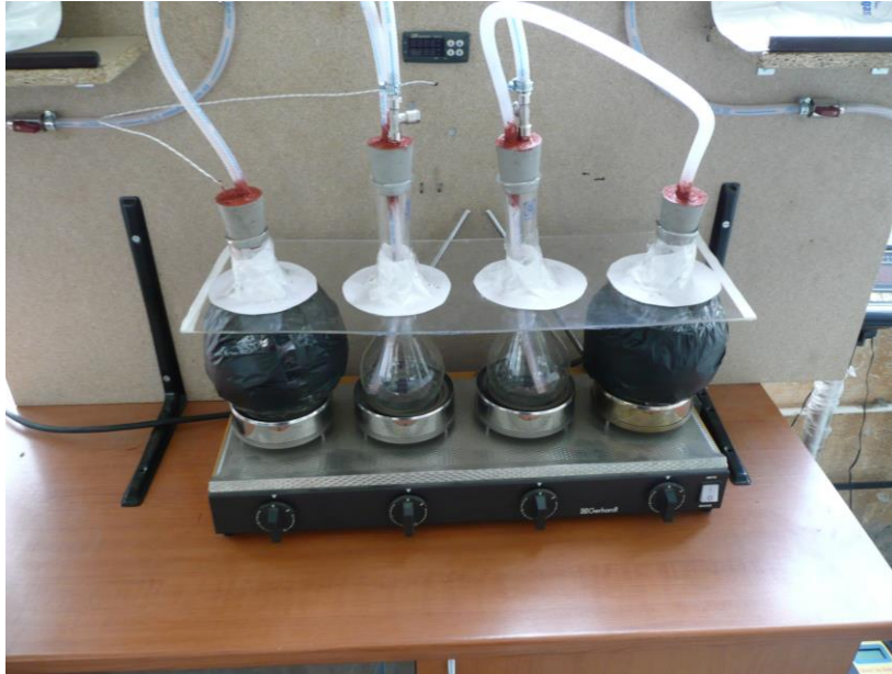
Figura 4.3. – Evidențierea acoperirii recipientelor de fermentație anaerobă
