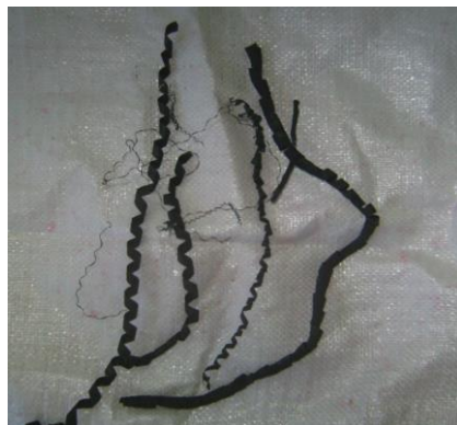
Figura 4.22. – Umplutură de șpan de oțel pentru filtrul de H 2 S
