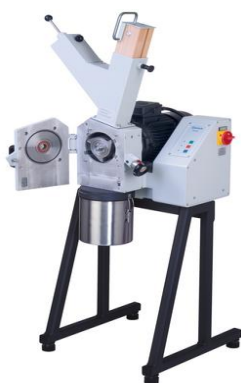
Figura 5.8. – Moară Retsch Sm 2000 [104]
