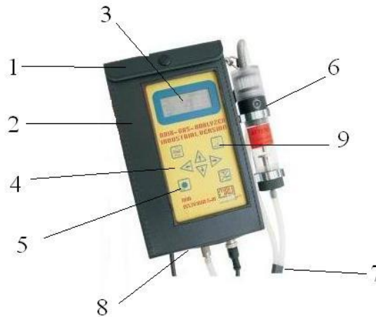
Figura 4.37. – Componenta analizorului Delta 1600 S IV [101] 1 – port conectare imprimantă externă, 2 – acumulator, 3 – afișaj, 4 – sistem de operare prin deplasare cu săgeți în meniul de control, 5 – comutator on – off, 6 – filtru captare picături apă, 7 – conexiune la sonda de prelevare gaz, 8 – conexiune la PC 9 – buton iluminare afișaj
