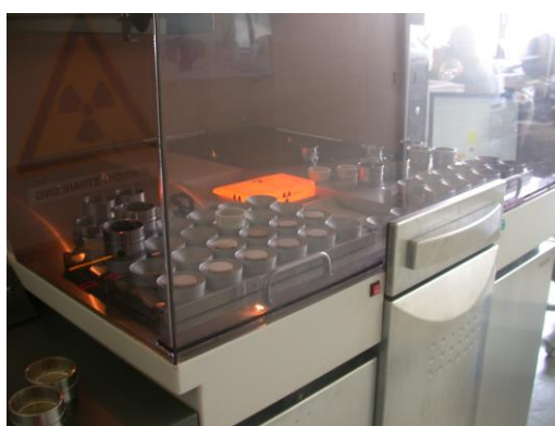
Figura 5.7. – Echipament de determinare a elementelor majore și metalelor grele din mostrele de biomasă.
