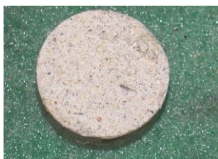
Figura 5.83. – Mostră reziduu rumeguș fag pregătită pentru introducerea în bomba calorimetrică
