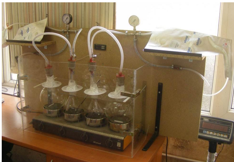
Figura 4.1. – Imagine de ansamblu a instalației de testare a mostrelor de biomasă
