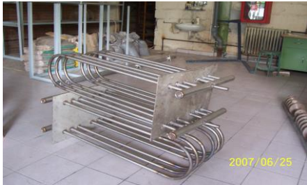
Figura 4.13. – Schimbătoarele de căldură folosite pentru instalație [11]
