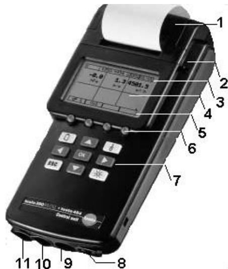
Figura 4.33. - Unitatea de control [106] 1 - imprimantă, 2 - creion electronic, 3 - bară pentru informații de sistem, 4 - afișare valori măsurate, 5 - bară pentru informații legate de funcționare, 6 - taste operare funcții, 7 - tastatură, 8 - conectare sondă presiune, 9 - conectare probă, 10 - conectare unitate de analiză, 11 - interfață tip serial.
