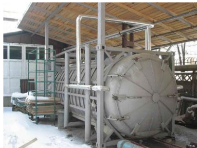
Figura 2.16. - Uscător în vacuum [105]
