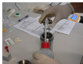
Figura 5.84. – Spălarea bombei calorimetrice cu apă distilată
