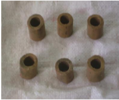
Figura 4.20. – Inele Raschig pentru filtrul spălător
