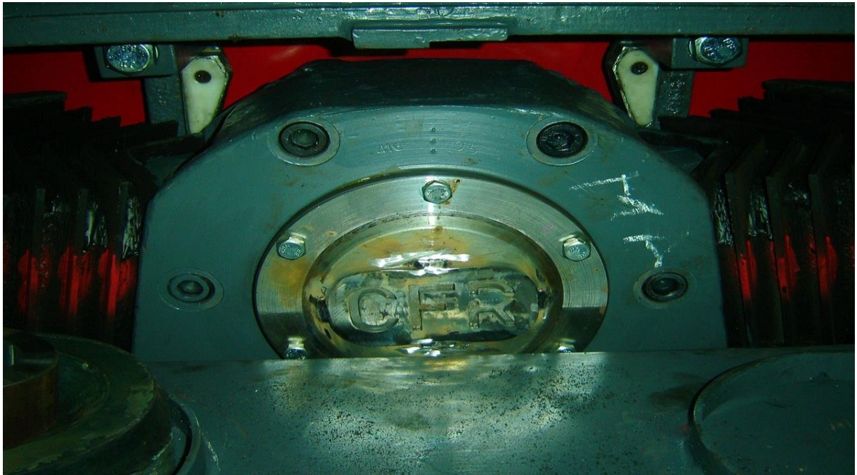
Fig. 7.18 – Montarea capacului lagăr al cutiei de osie
