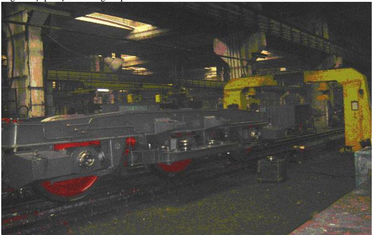
Fig. 7.19 – Poziționare boghiu pe standul de încercări
