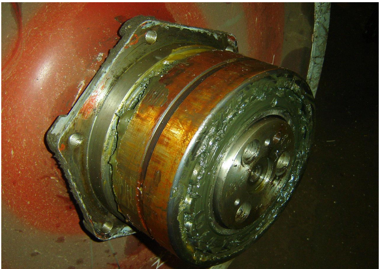
Fig. 7.15 – Rulmentul montat pe fusul osiei
